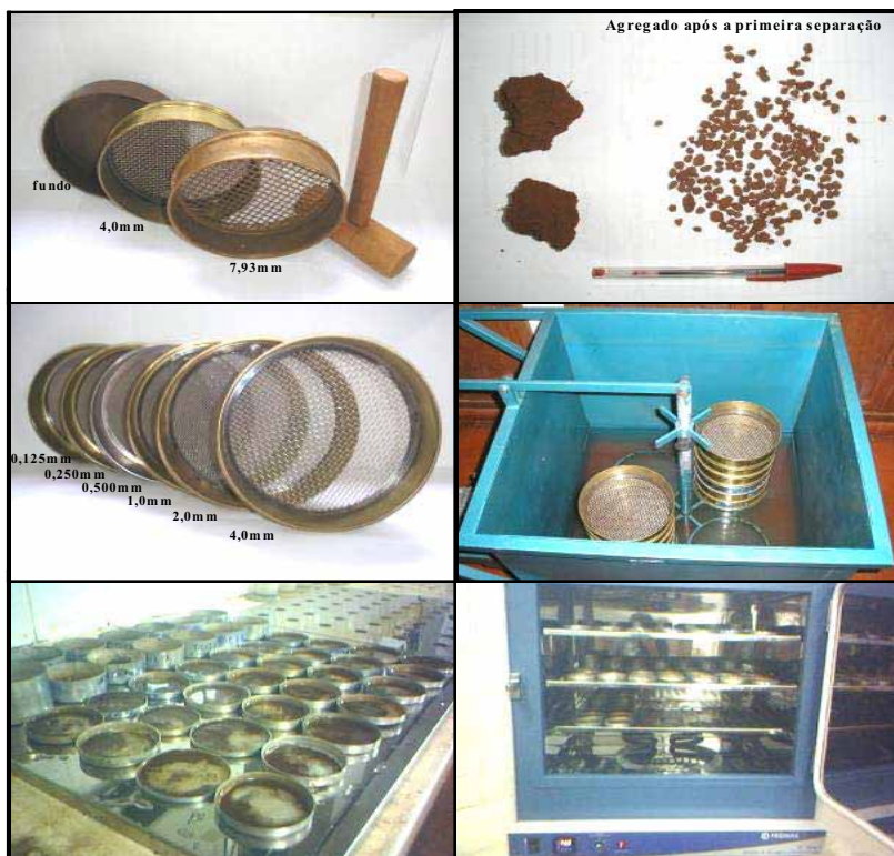
Figura 3.8. Equipamentos utilizados na análise da estabilidade do agregado (SIQUEIRA, 2007).
