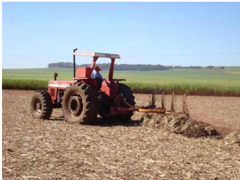
Figura 3.5. Trator MF 292 TDA acoplado a uma enleiradora de palha. Equipamentos utilizados para remoção da palhada sobre o solo nos tratamentos ERs e SPs.
