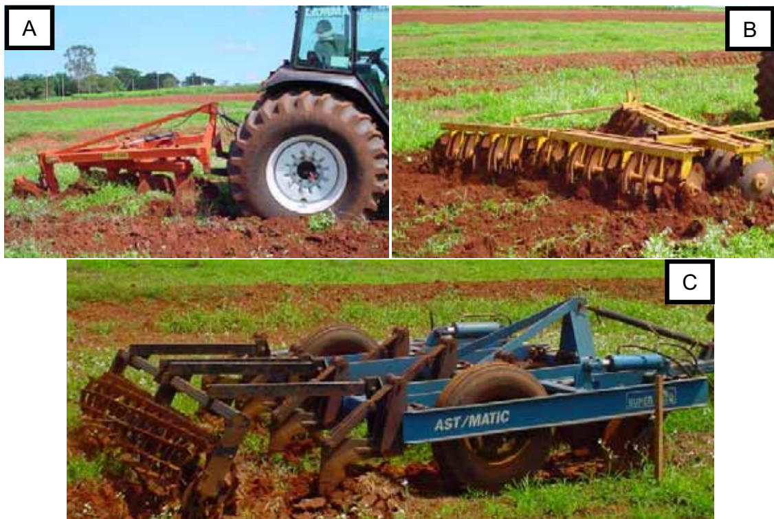
Figura 2.2. Tratamentos avaliados no experimento: (A) e (B) Conv; (C) Red. (A) Arado de disco reversível, (B) Grade niveladora de arrasto e (C) Escarificador de arrasto conjugado com rolo destorroador.
