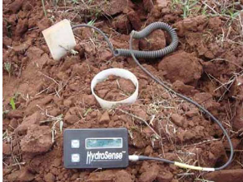
Figura 2.5. “Hydrosens”, sistema portátil utilizado para medição da umidade do solo.
