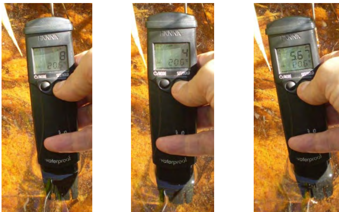
Figura 6. Coleta de dados de temperatura, condutividade, sólidos e pH da amostra 5, na microbacia 8, em 21 de novembro de 2008.
