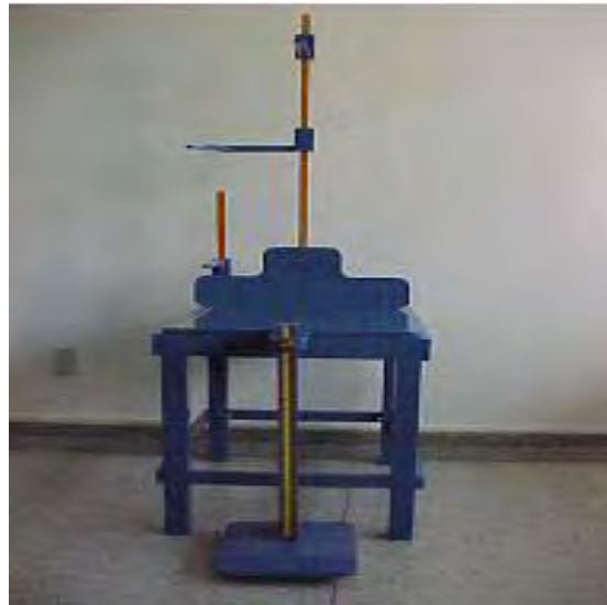
Figura 1. Cadeira antropométrica, com base em Serrano (1996), utilizada em trabalhos anteriores ao atual relatório (Fonte, acervo próprio).
