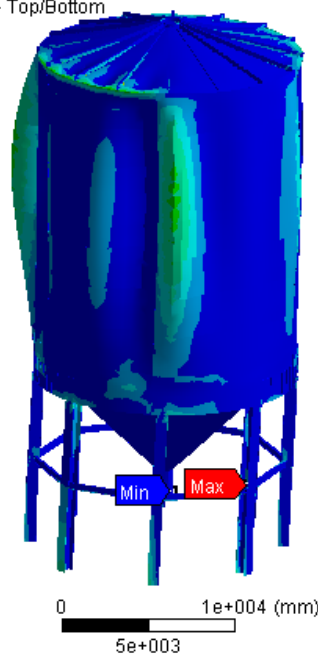
Figura 40 - Panorama de tensões no fermentador, PP + VT
