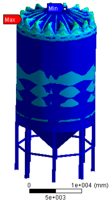
Figura 44 - Panorama das deformações no fermentador, PP + OP
