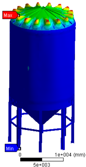
Figura 45 - Panorama dos deslocamentos máximos no fermentador, PP + OP
