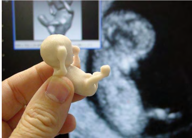
Figura 7 – Protótipo de feto de 12 semanas. Ao fundo e à direita, imagem de Ultra-Som; acima e à esquerda, biomodelo virtual; em primeiro plano, protótipo do feto ( http://itabatanews.com.br/leitor.php?cod=1546 ).
