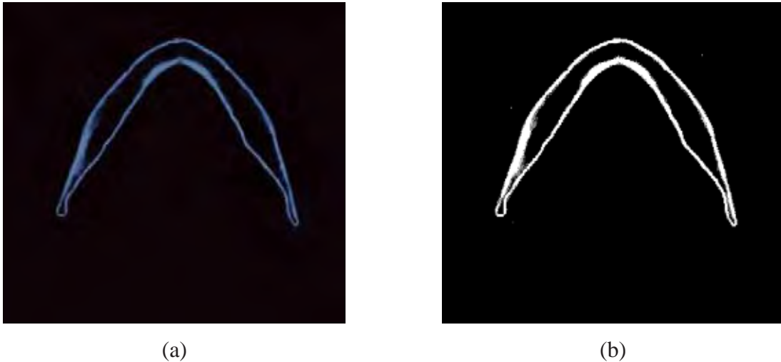
Figura 3.3 – (a) Imagem sem aplicação da limiarização (b) Imagem após a aplicação da limiarização.
