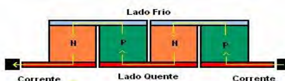
Figura 8: Transferência de calor via pastilha Peltier (STRAZZA e RIBERI, 2004).
