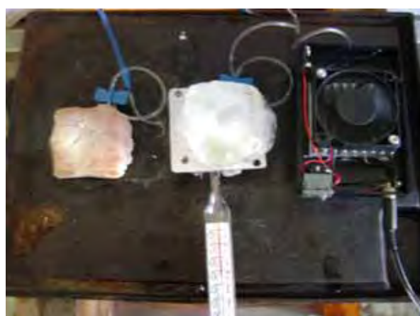
Figura 31: Medição de temperatura do corpo de prova (amostra B).
