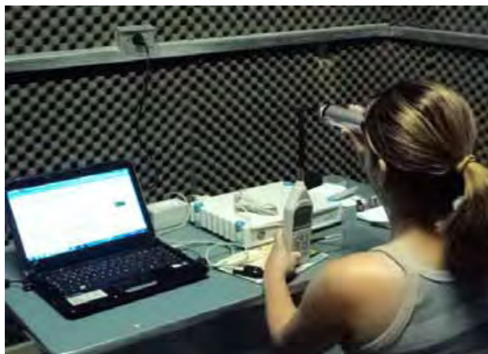
Figura 2.6 : Procedimento de calibração microfone- estetoscópio
