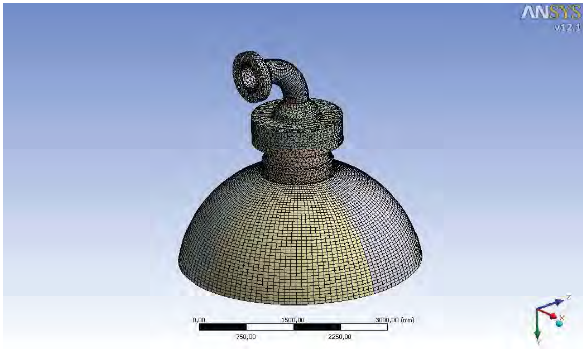
Figura 5.20 – Malha gerada para análise das cargas de tubulação no bocal superior.
