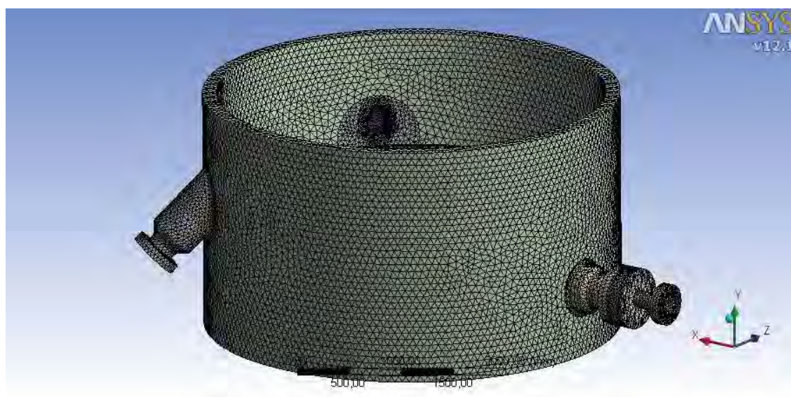
Figura 5.92 – Malha gerada para o modelo de análise dos bocais de descarte, quench e anel de suporte do leito.
