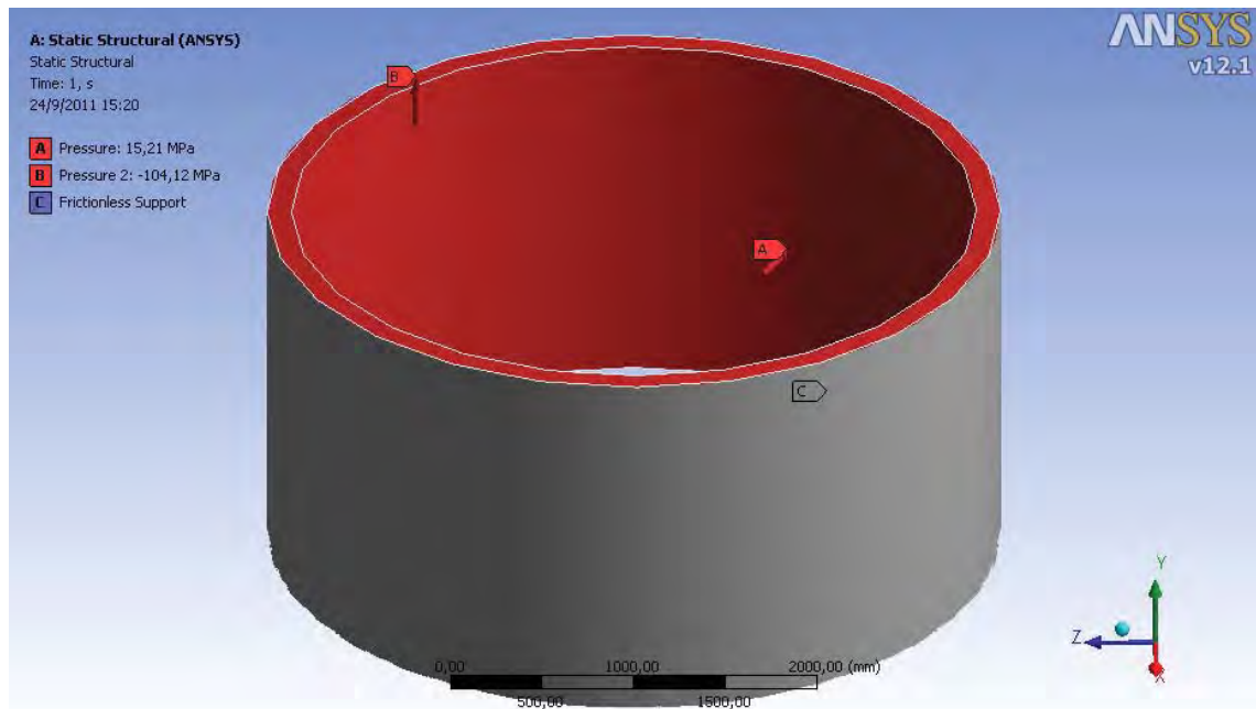
Figura 5.2 - Carregamentos e condições de contorno.
