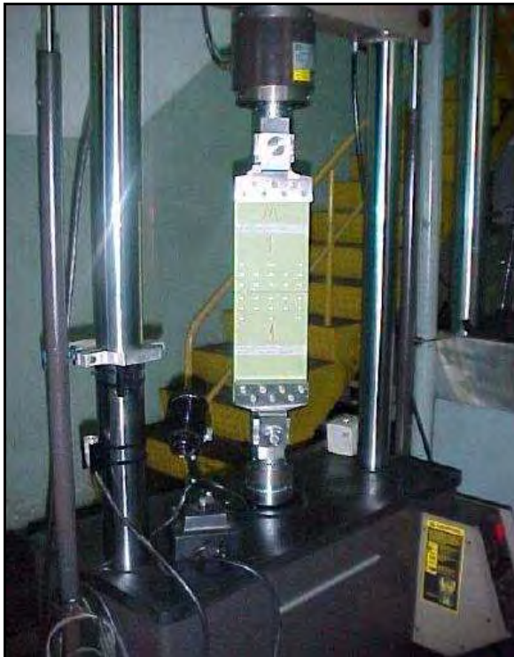
Figura 36 - Máquina de testes universal MTS 25" (SPINELLI, 2004)
