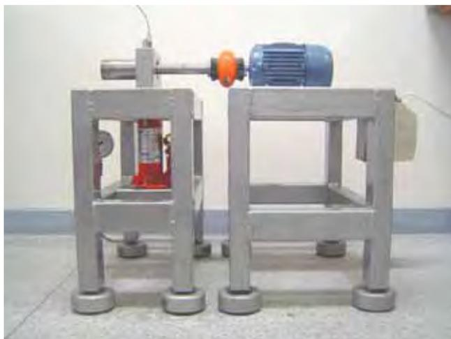
Figura 9 - Versão aprimorada da bancada de ensaios de mancais de rolamento (UNESP, 2004)
