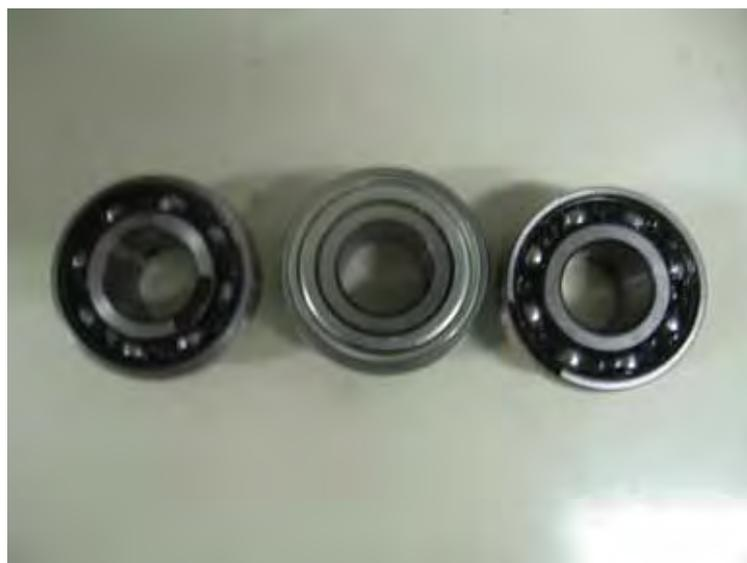
Figura 74 - Rolamentos para troca: defeito em pista interna, sem defeito e defeito em pista externa, respectivamente.
