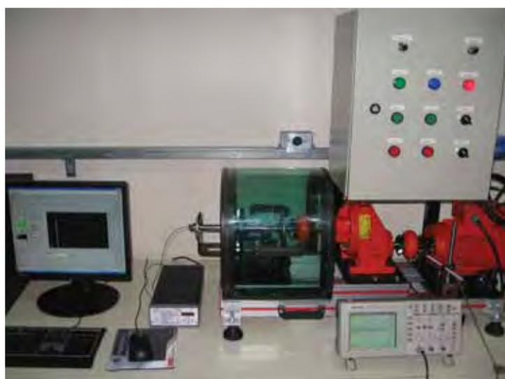
Figura 54 - Montagem do sistema de aquisição para avaliação de desempenho da bancada.
