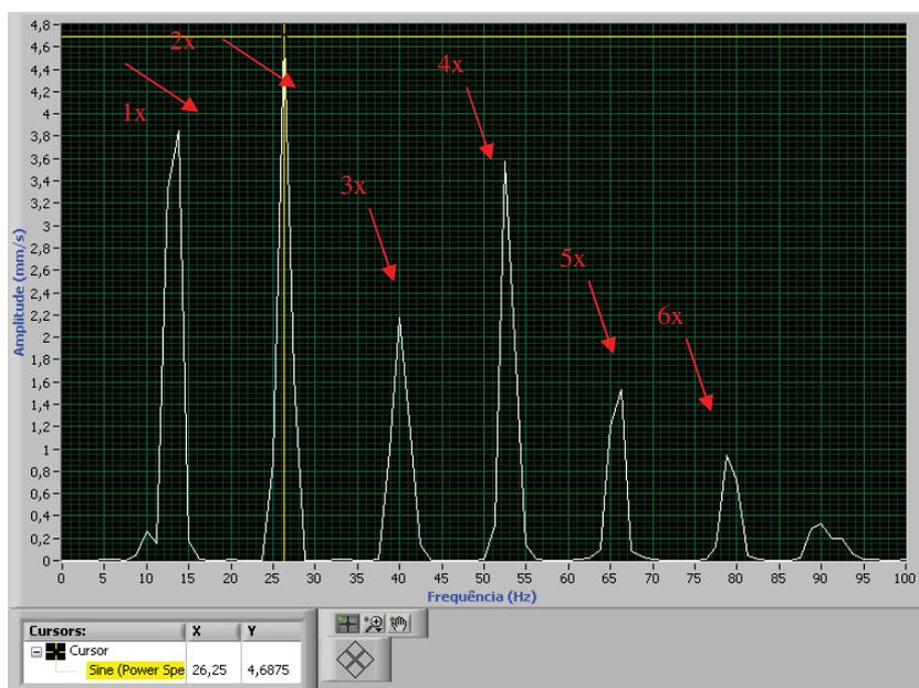
Figura 81 - Análise do sinal no domínio da frequência em condição de folga mecânica.
