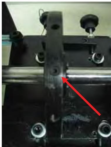
Figura 65 - Fixação de prisioneiro no disco de desbalanceamento.
