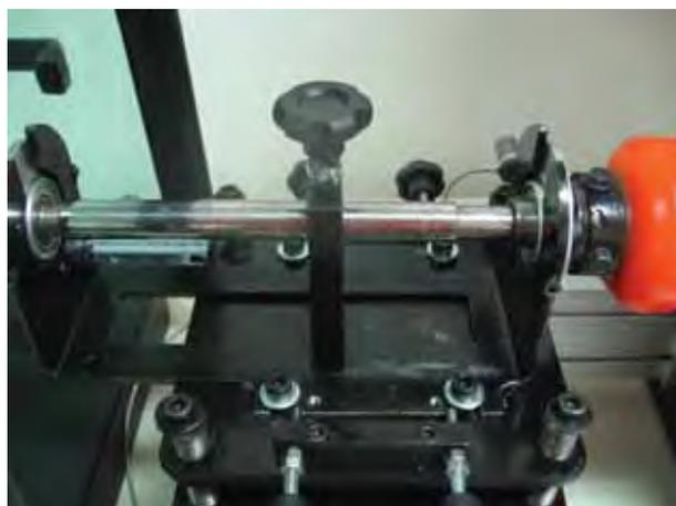
Figura 88 - Montagem da bancada com o dispositivo para efeito de roçamento em eixos.
