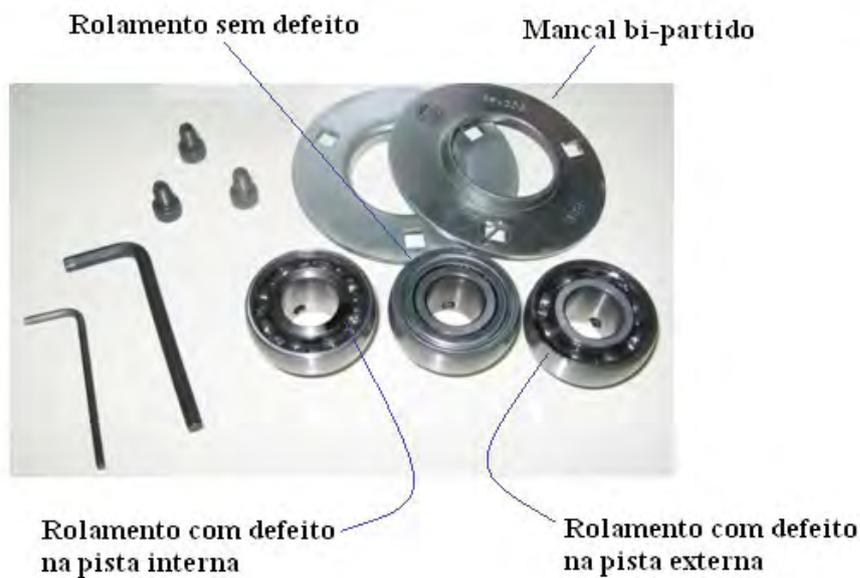
Figura 30 - Kit de rolamento e identificação de defeitos nos rolamentos – BMT1
