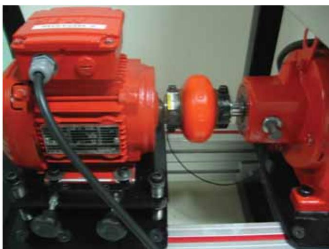
Figura 60 - Montagem da bancada na versão de resistência motora.
