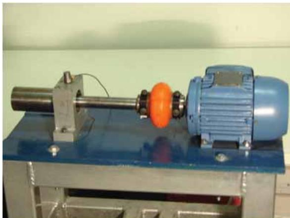
Figura 1 - Bancada de ensaios de falhas em mancais de rolamento (UNESP, 2012)
