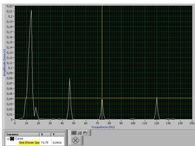
Figura 64 - Análise do sinal no domínio da frequência em condição inicial (Versão com motor de resistência-ligado).
