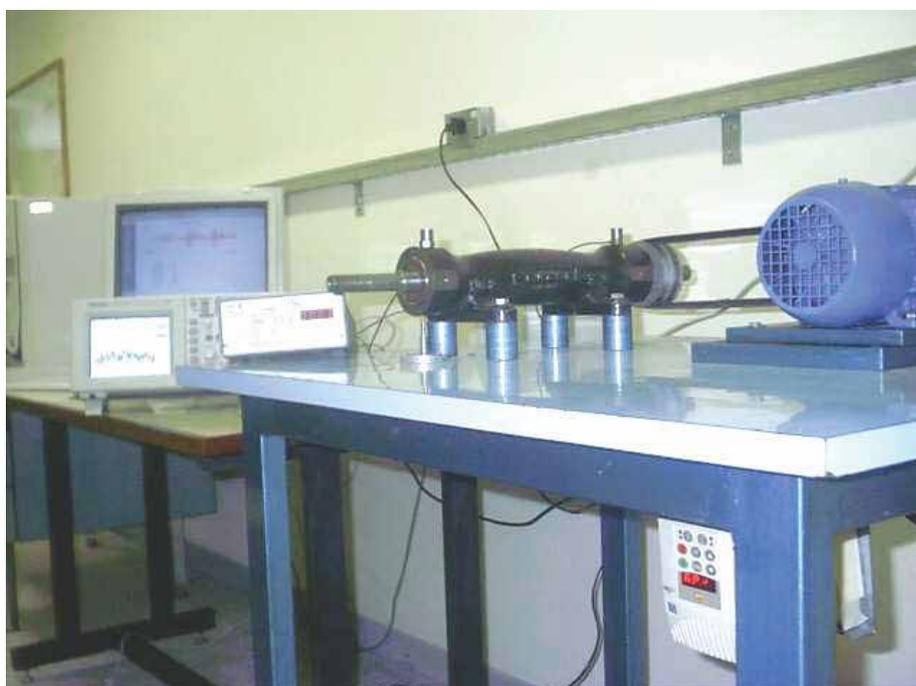
Figura 8 - Projeto piloto da bancada de ensaios de mancais de rolamentos (UNESP, 2002).
