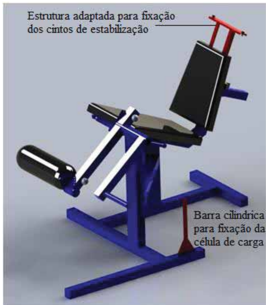
Figura 23 - Barra cilíndrica adaptada para fixar a célula de carga à cadeira
