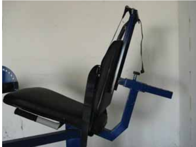
Figura 26 - Regulagem de retração do encosto
