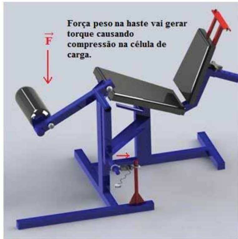
Figura 36- Angulação da haste gera torque pela presença da força peso
