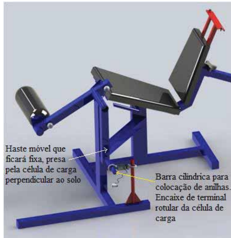
Figura 24 - Barra cilíndrica fixada à haste móvel - onde será encaixada a célula de carga
