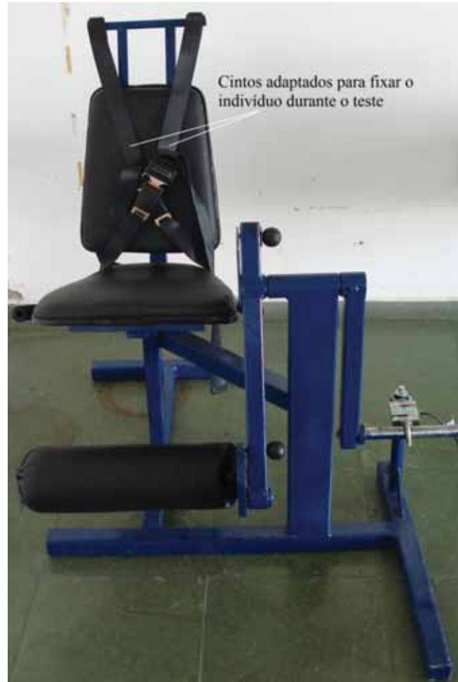
Figura 28 - Cintos para estabilização dos indivíduos durante a avaliação.
