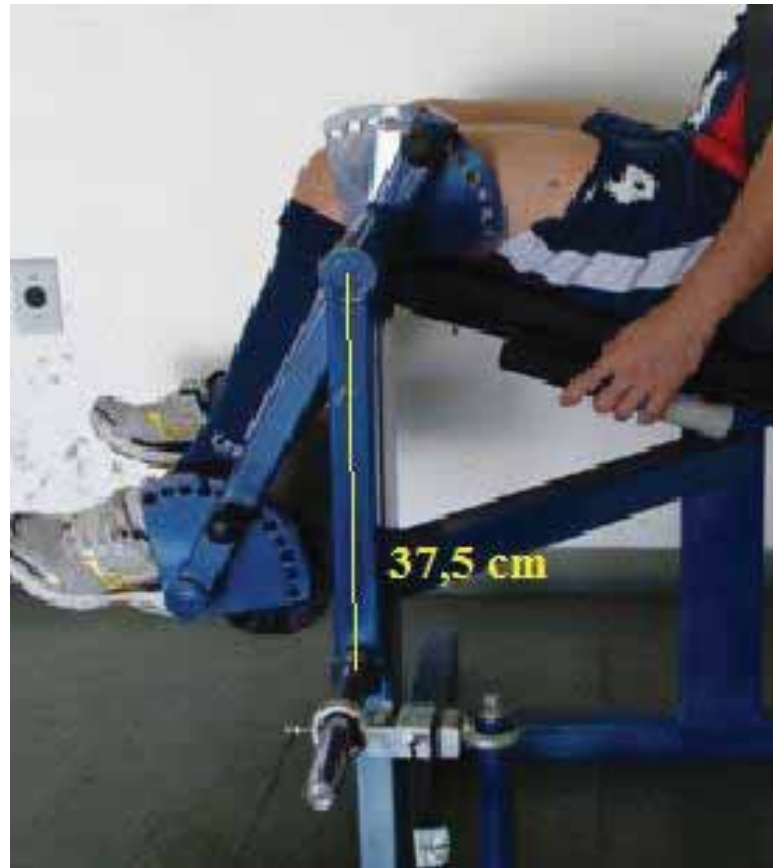
Figura 41 – Medida do braço de alavanca entre o ponto de fixação da célula de carga e o eixo de rotação da haste fixa.
