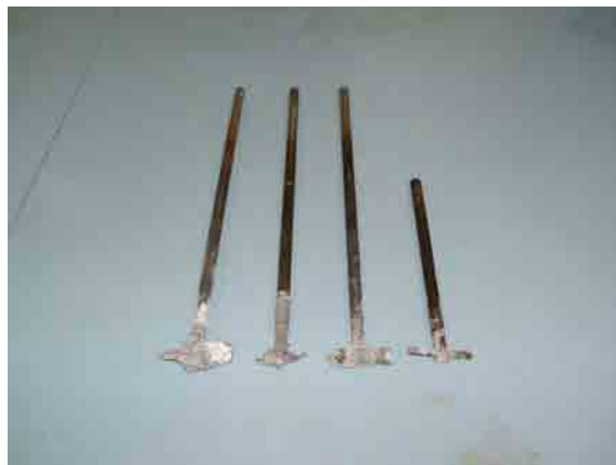
Figura 4.7 – Hastes utilizadas. Observe-se o desgaste causado pelo ataque do alumínio
