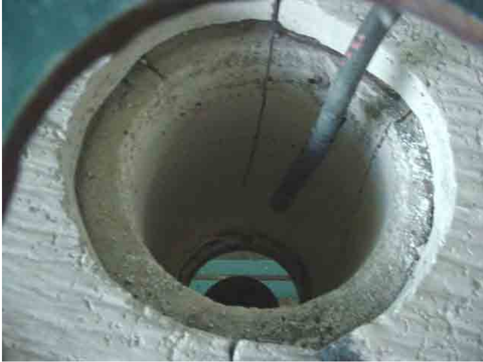
Figura 4.12 – Vista do interior do forno com tubo para injeção de argônio, à direita, e termopar, à esquerda. A Figura mostra também a tampa do forno, com furo central, em forma de rosca bipartida. As trincas na parede interior do forno são consideradas normais.
