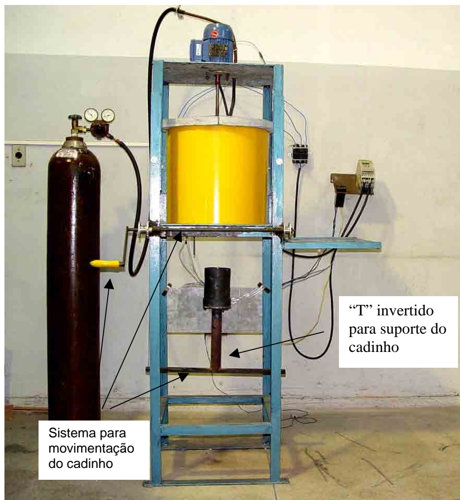
Figura 4.15 – Detalhe do cadinho e o sistema de movimentação. A manivela, à esquerda da Figura, aciona os cabos de aço que movimentam a travessa de suporte do cadinho
