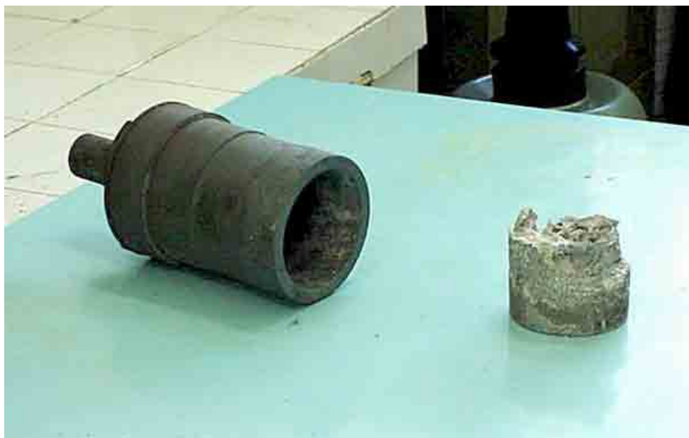
Figura 4.13 – Cadinho com primeiro lingote fundido com forte oxidação
