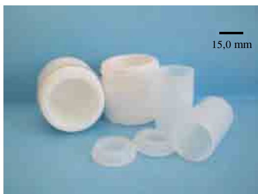
Figura 3.5 - Moldes utilizados para confecção das peças cerâmicas destinadas à microscopia óptica.
