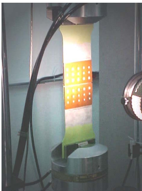
Figura 3.11 – Luz polarizada sendo incidida sobre a placa fotoelástica.
