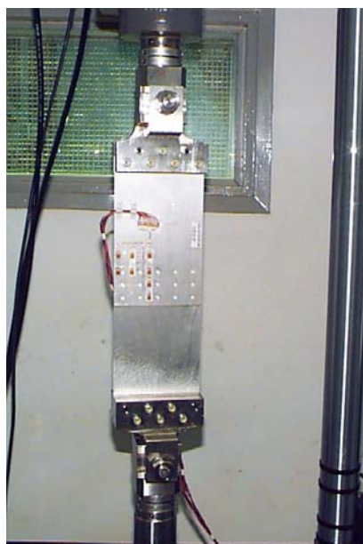
Figura 3.6 - Cdp pronto para o ensaio de tração monotônico.
