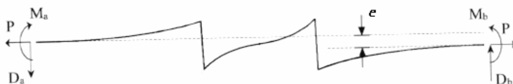
Figura 2.12 – Deflexão da linha neutra para a junta sobreposta (adaptado de Rijck e Fawaz, 2000).
