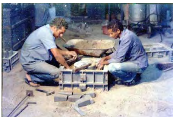
Figura 56 – Preparação para colocação dos canais Figura 57 - Posicionamento dos canais de alimentação
