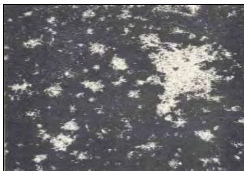
Figura 31 - Corrosão devido a contaminação do fluxo com cloreto sobre a superfície do magnésio (EMLEY, 1966)
