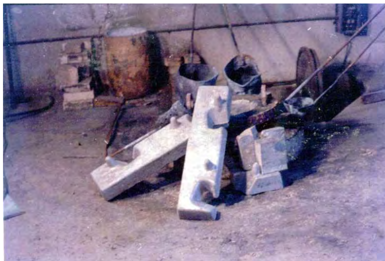
Figura 69 – Ferramentas (painéis, escumadeiras, conchas, sino) usadas na fusão do Magnésio.
