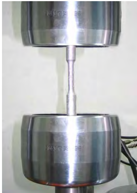
Figura 76 – Garra da INSTRON com Corpo de Prova para Ensaio Mecânico.
