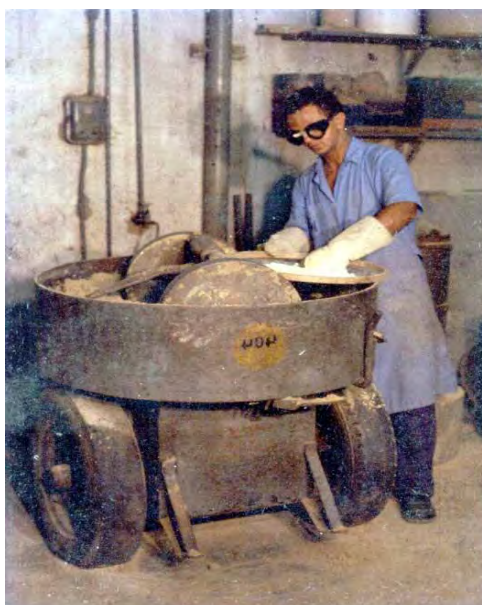
Figura 40 – Misturador utilizado na preparação da areia de moldagem
