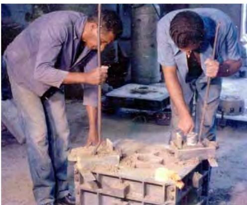
Figura 64 – Preparação das bacias de vazamento
