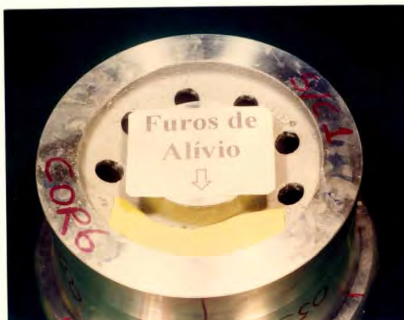
Figura 4. Fotografia FC 3/93. Pos. 11. Mostra a região denominada como furos de alívio em um semi-cubo.
