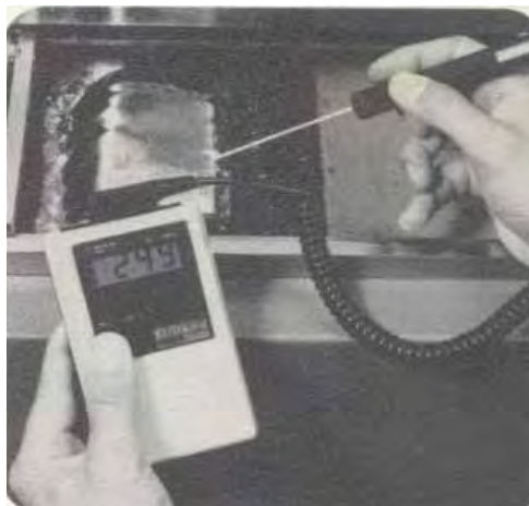
Figura 25 – Medidor digital de temperatura do banho metálico
