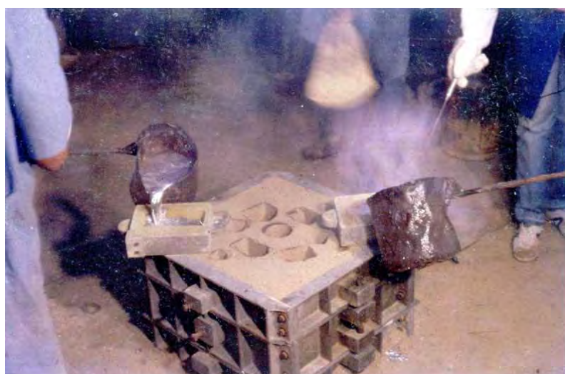
Figura 70 – Mostra da técnica de vazamento do semicubo através de duas frentes de vazamento.
