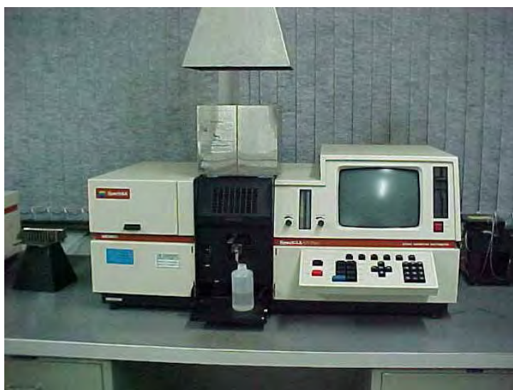
Figura 73 – Espectrofotômetro de Absorção Atômica.
