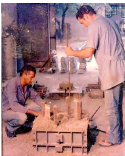
Figura 58 - Preenchimento e Compactação da Areia de Moldagem
