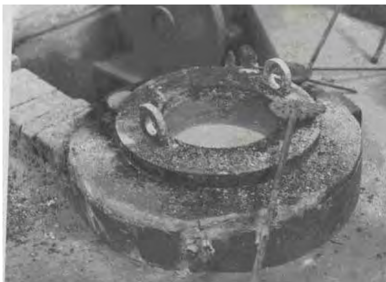
Figura 68 – Forno a óleo combustível com cadinho removível.
