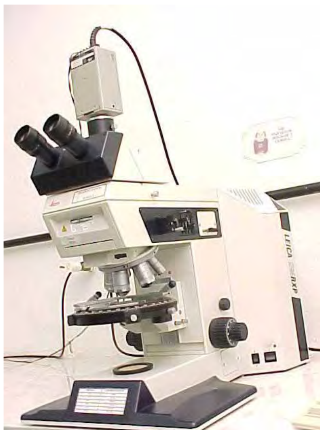
Figura 74 – Microscópio Óptico Leica, modelo DMRXP
