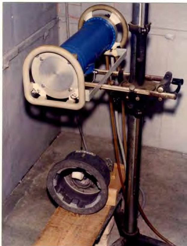
Figura 5. Fotografia FC 3/93. Pos. 21. Mostra o arranjo tubo/ peça/ filme, objetivando a radiografia da banda.
