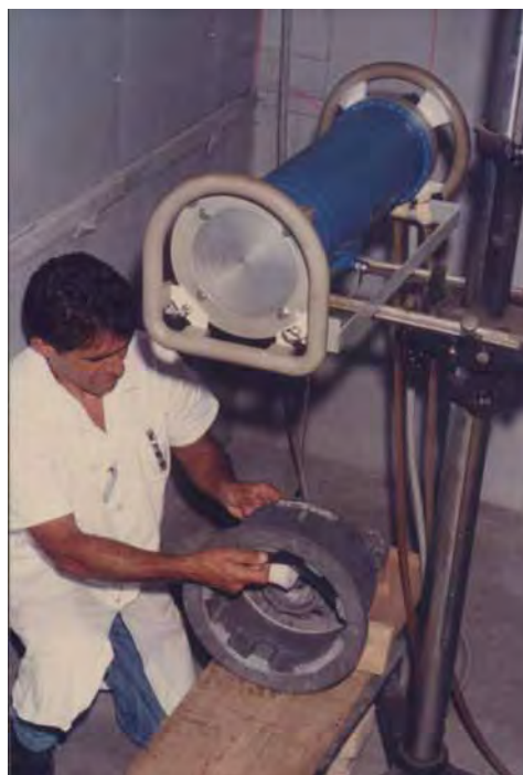
Figura 78 – Aparelho de Raios-X, marca Andrex, modelo CMA20.
