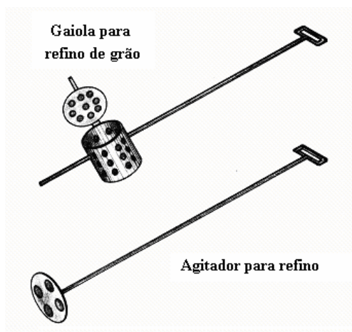
Figura 26 – Equipamento usado no refino do grão de magnésio
