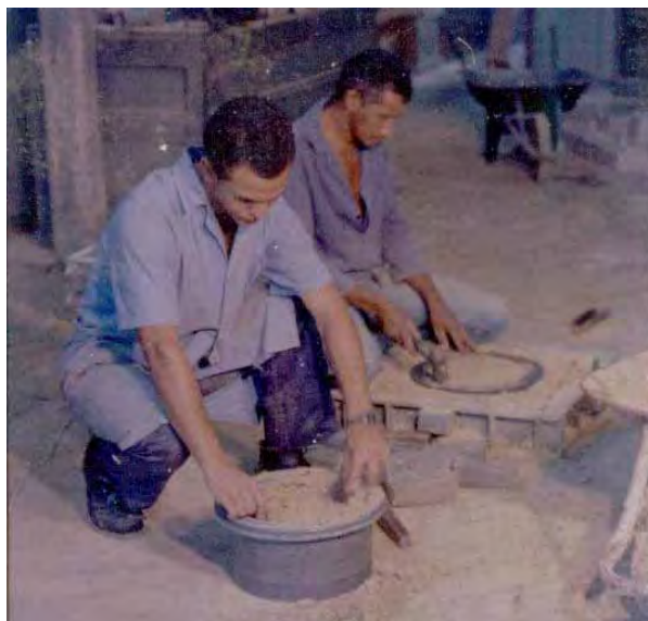
Figura 54 - Moldagem do Macho Interno e colocação do resfriador na caixa base
