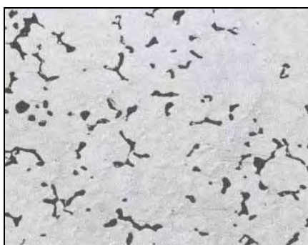
Figura 34 - Microporosidade de contração. Liga AZ92A-T6 fundida em areia verde. 100x. (AVEDESIAN; BAKER, 1999).
