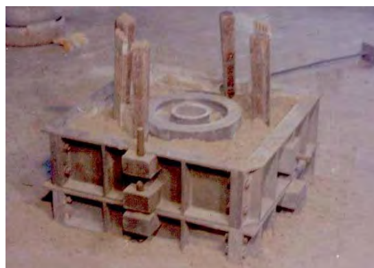
Figura 56 – Preparação para colocação dos canais Figura 57 - Posicionamento dos canais de alimentação
