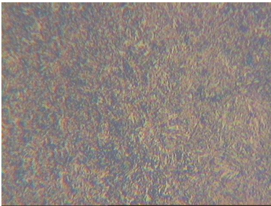
FIGURA 4.2: Fotomicrografia do aço 1045 na condição temperado revenido. Ampliação 250X. Temperado a 850 °C por 30 min. e revenido a 300 °C por 50 min. Microestrutura formada por martensita revenida. Ataque químico com Nital 2%.
