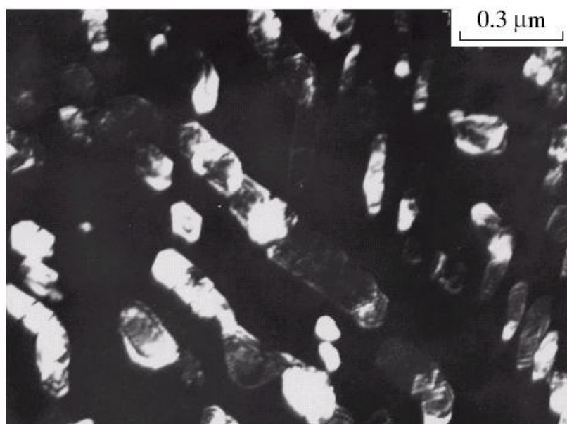
FIGURA 2.10: Imagem em campo escuro da microestrutura perlítica com g=11c reflexão após decomposição a 600\text{ }^{\circ}\text{C} e recozimento adicional a 700\text{ }^{\circ}\text{C} por 30 h (SCHASTLIVTSEV E COLABORADORES, 2002).
