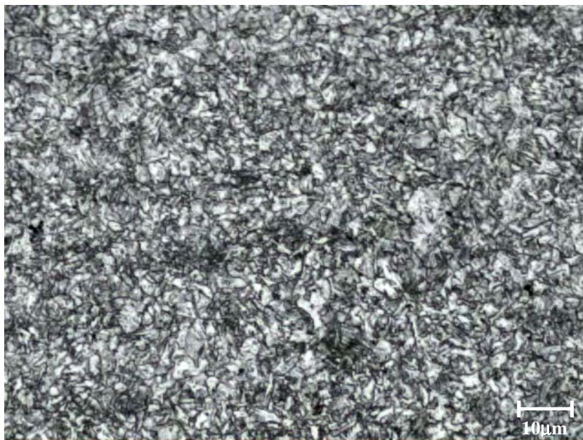
Figura 50 – CP17.3. Fotomicrografia do aço analisado após tratamento de austenitização, resfriamento rápido e revenimento (condição D). Microestrutura contendo possivelmente bainita. Sentido longitudinal de laminação.
