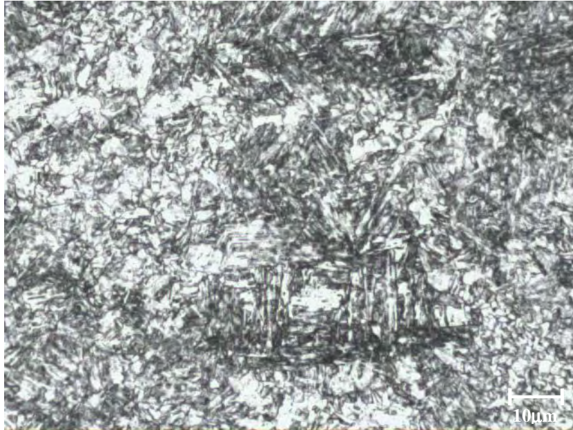
Figura 51 – CP21.1. Fotomicrografia do aço analisado após tratamento de austenitização, resfriamento rápido, revenimento e tratamento pós-soldagem (condição E). Microestrutura contendo possivelmente bainita. Sentido longitudinal de laminação.
