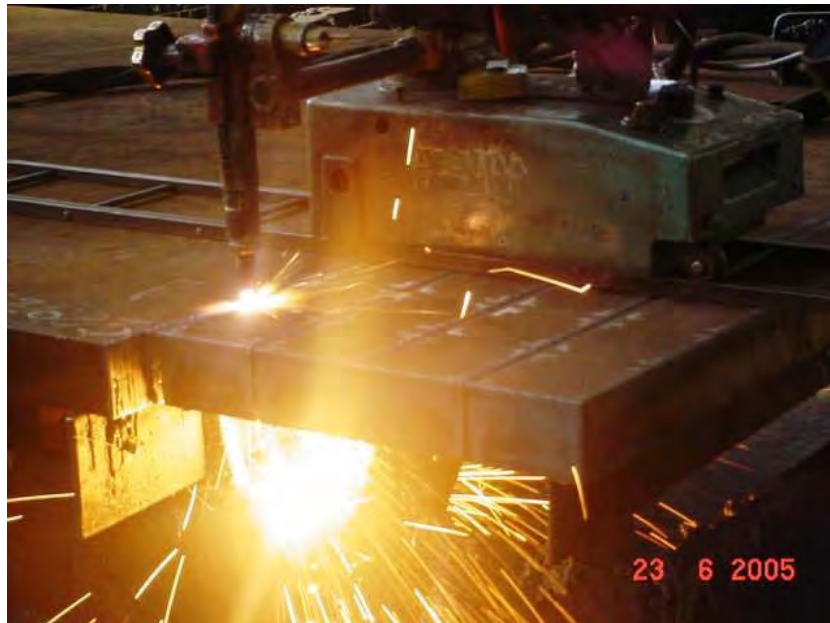
Figura 17 – Foto do processo de oxicorte.
