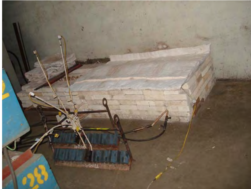
Figura 25 – Foto externa do forno de tratamento térmico.
