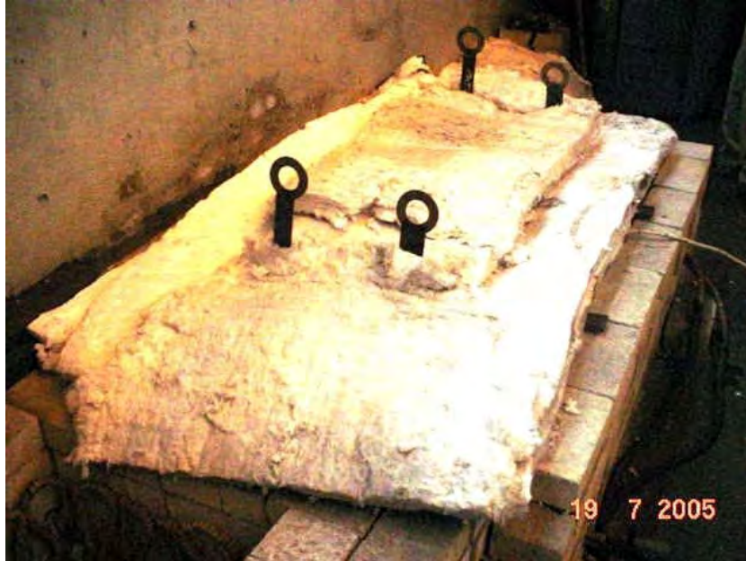
Figura 27 – Foto do revestimento externo de lã utilizado no forno.
