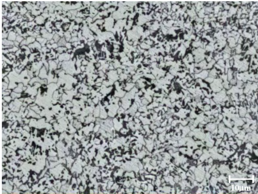
Figura 44 – CP5.3. Fotomicrografia do aço analisado após tratamento de austenitização (condição A). Microestrutura contendo ferrita (tonalidade cinza claro) e bandas de perlita (tonalidade cinza escura). Sentido longitudinal de laminação.
