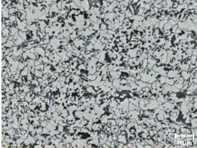
Figura 43 – CP5.1. Fotomicrografia do aço analisado após tratamento de austenitização (condição A). Microestrutura contendo ferrita (tonalidade cinza claro) e bandas de perlita (tonalidade cinza escura). Sentido longitudinal de laminação.
