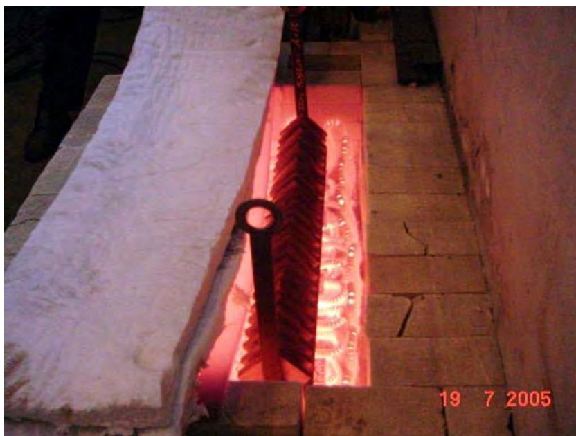
Figura 26 – Foto interna do forno de tratamento térmico.
