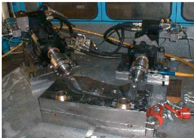
Figura 22 - Ferramenta utilizada pela Porsche para hidroconformação de um componente da porta do projeto ULSAC (ULSAC Engineering Report, 2000).
