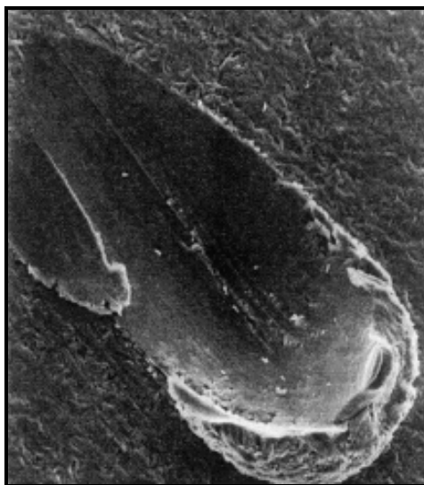
Figura 2.15 – Cratera formada pelo impacto de uma única partícula sobre a superfície de alumínio 1100-O (LEVY, 1986 apud HUTCHINGS; LEVY, 1989).
