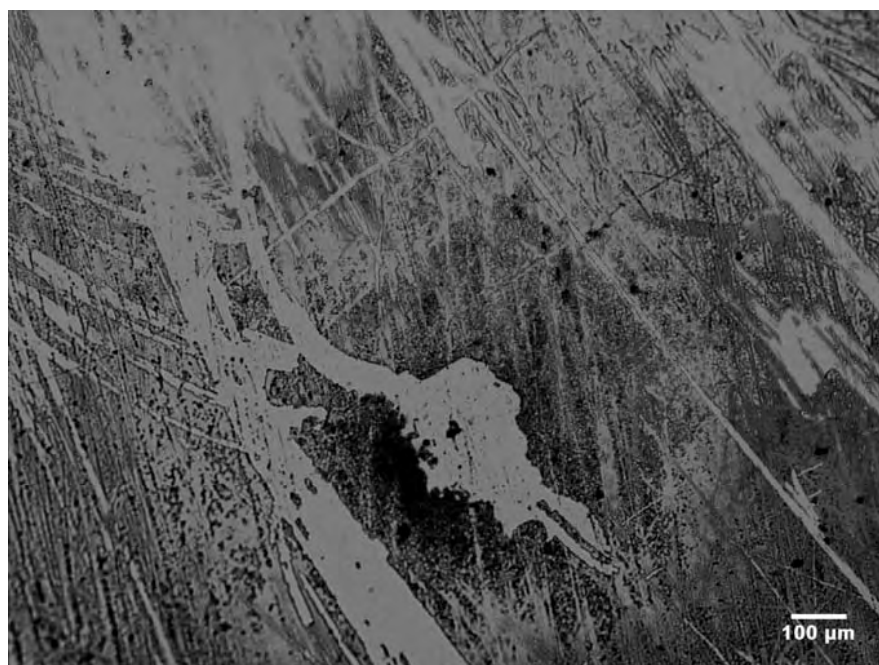
Figura 78 – Micrografia óptica da superfície da liga Wironia MRL após o ensaio de imersão (Lado 2)
