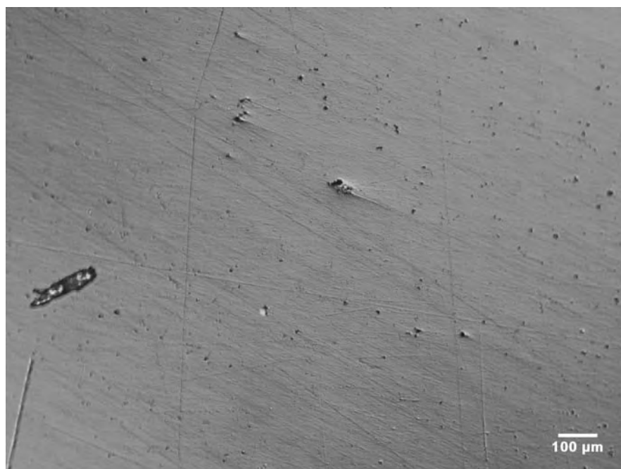
Figura 71 – Micrografia óptica da superfície da liga Wiron 99 MRL antes do ensaio de imersão
