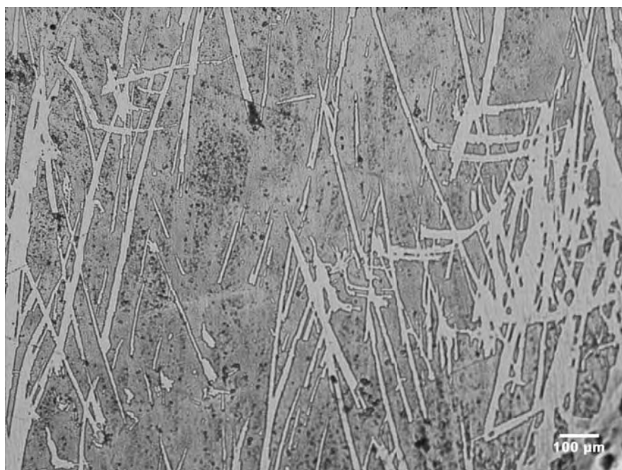
Figura 75 – Micrografia óptica da superfície da liga Wironia IRR após o ensaio de imersão (Lado 2)
