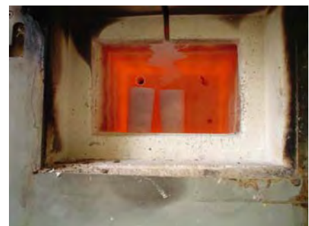
Figura 7 – Moldes no forno a 800°C
