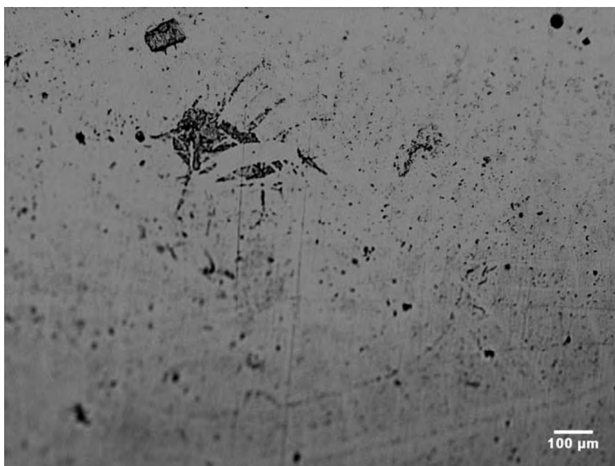
Figura 74 – Micrografia óptica da superfície da liga Wironia IRR após o ensaio de imersão (Lado 1)
