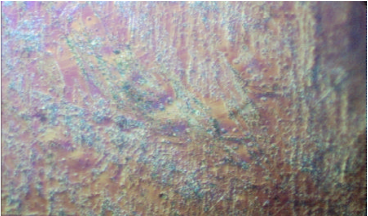
Figura 12 - Micrografia óptica da superfície frontal da chapa zincada
