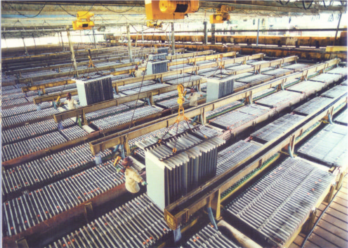
Figura 2 - Cubas de eletrólise (Cia Paraibuna de Metais)
