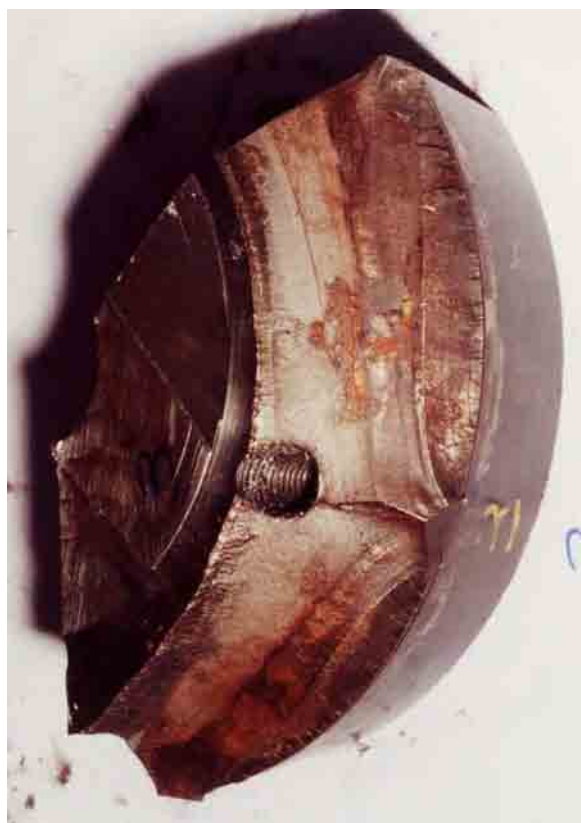
Figura 5.7 - Parte fraturada onde se apresentam marcas de praia
