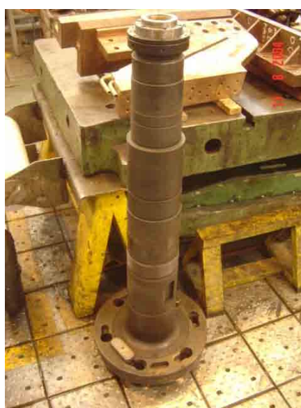
Figura 5.8 - Árvore nova a ser instalada na máquina de laminação LEIFELD
