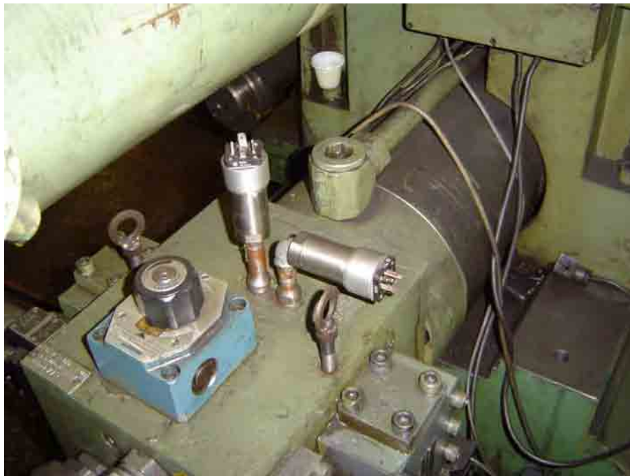
Figura 3.5 - Transdutores de pressão acoplados no cilindro hidráulico da mesa
