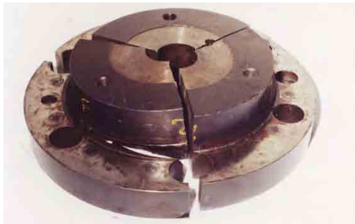
Figura 5.6 - Fratura entre a aba e o nariz da árvore
