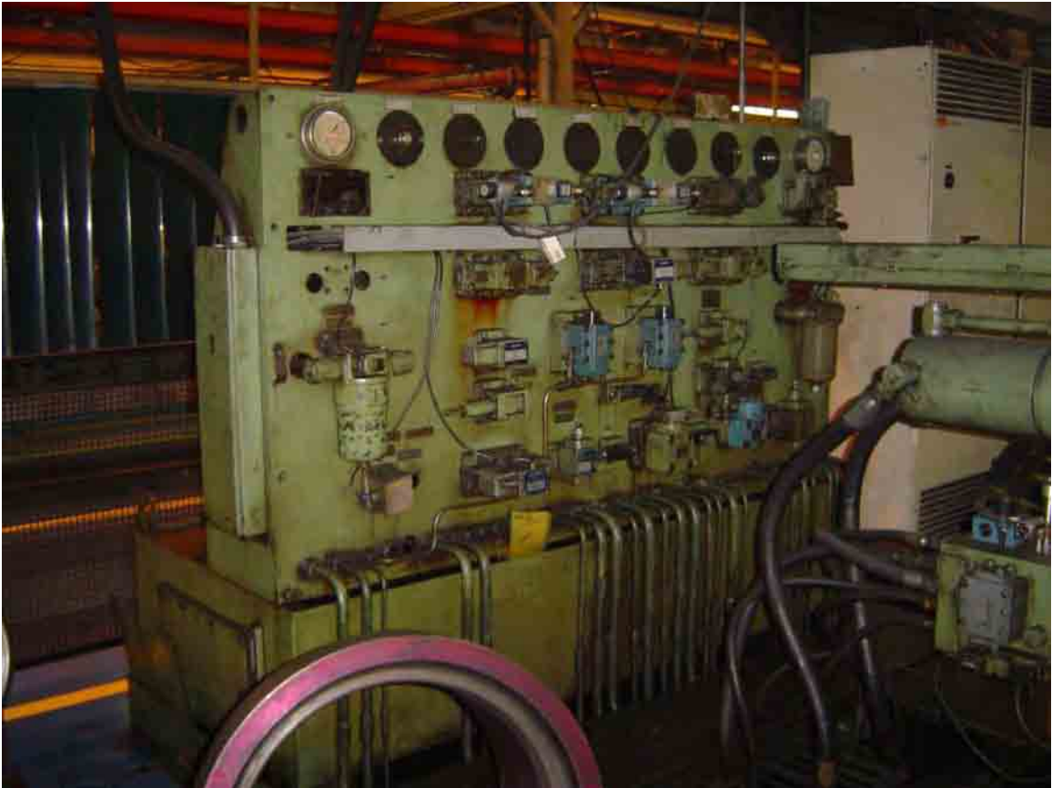
Figura 3.6 - Painel hidráulico e mangueiras de alta pressão que alimentam o cilindro de avanço
