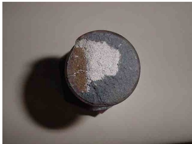
Figura 2.17 - Parafuso da tampa de uma válvula de turbina (HEIN, 2003)
