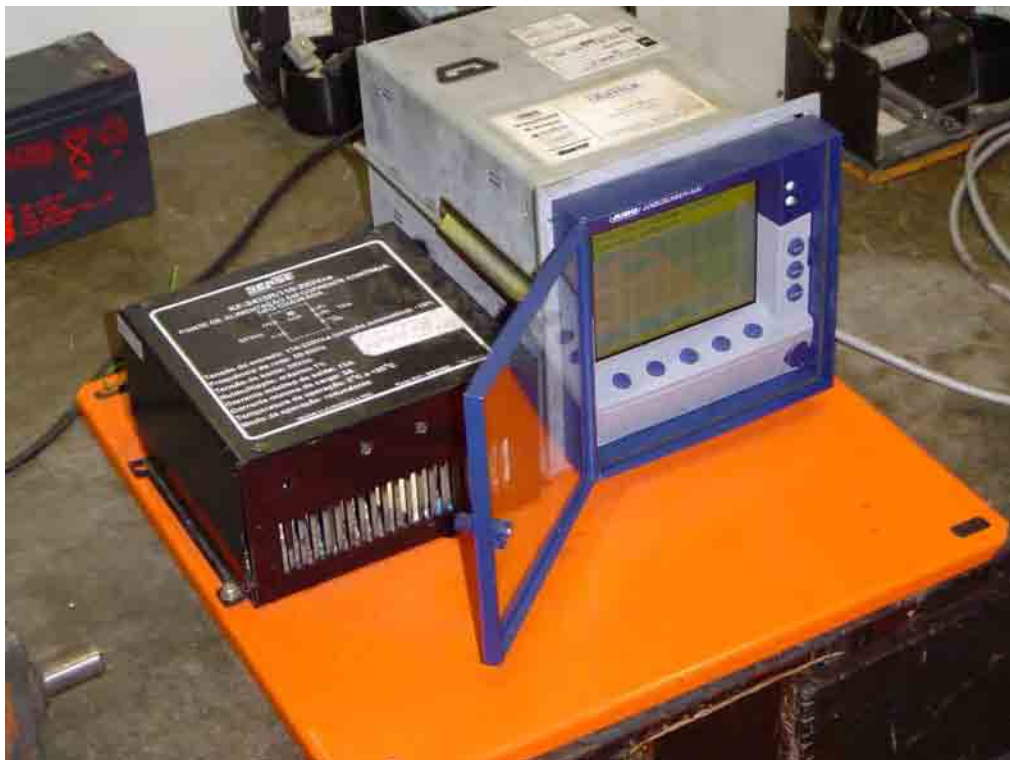
Figura 3.2 - Coletor de dados marca JUMO tipo Logoscreen 500 e sua fonte
