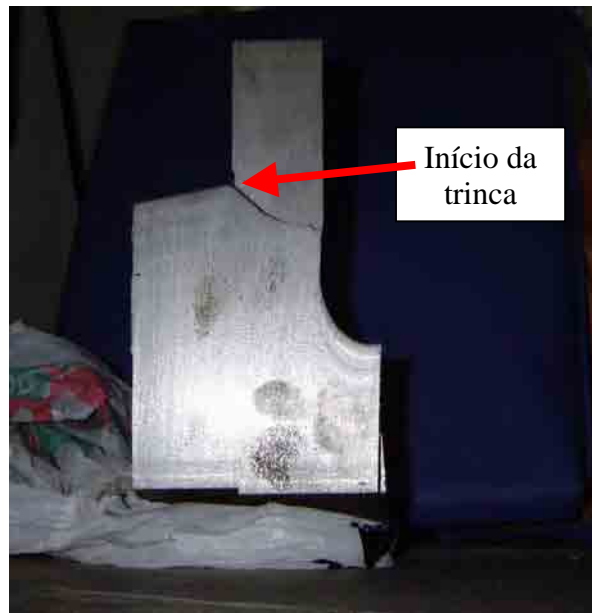
Figura 5.5 – Detalhe da árvore em perfil fraturado
