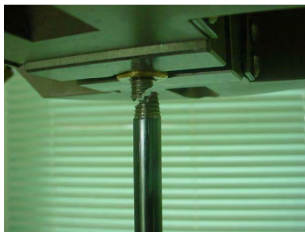
Figura 4.8 - Momento da fratura do corpo de provas da haste
