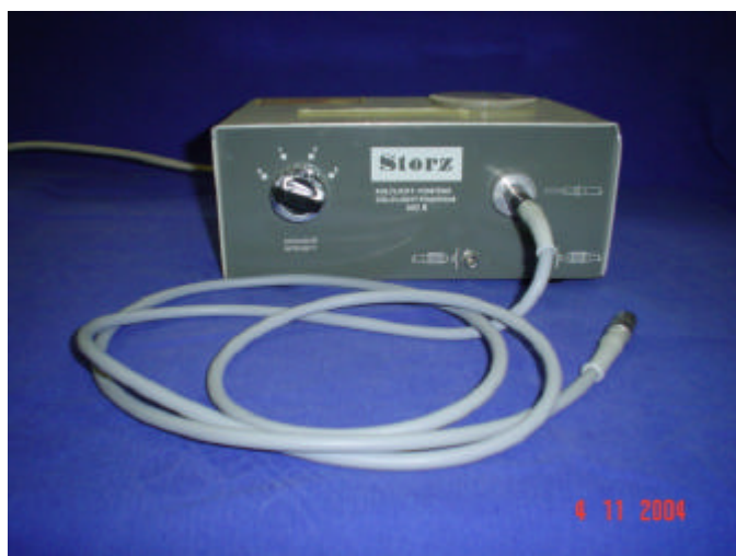
Figura 27 - Fonte de luz marca Storz já acoplada ao seu cabo de fibra óptica
