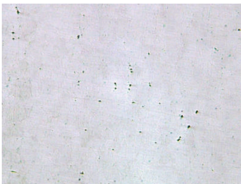
Figura 6.1 – Pontos de inclusões de alumina no material (aumento de 100 X - sem ataque).
