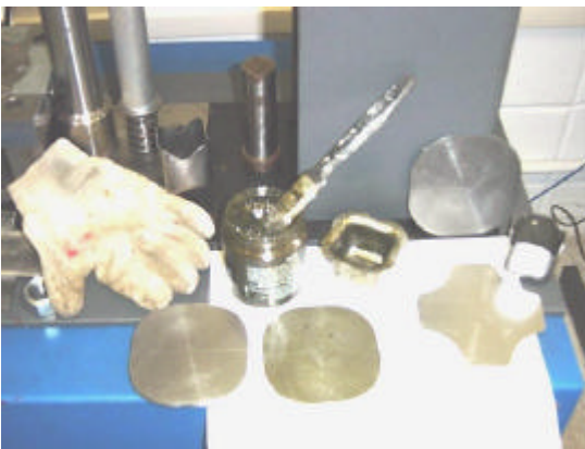
Figura E.5 - Lubrificação do blank.
