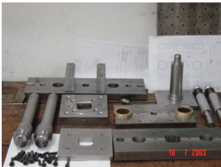
Figura 6.11- Foto da ferramenta para estampagem da caixa - peças .
