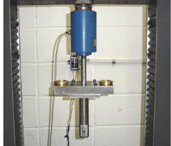
Figura E.2 - Detalhe da montagem do punção.
