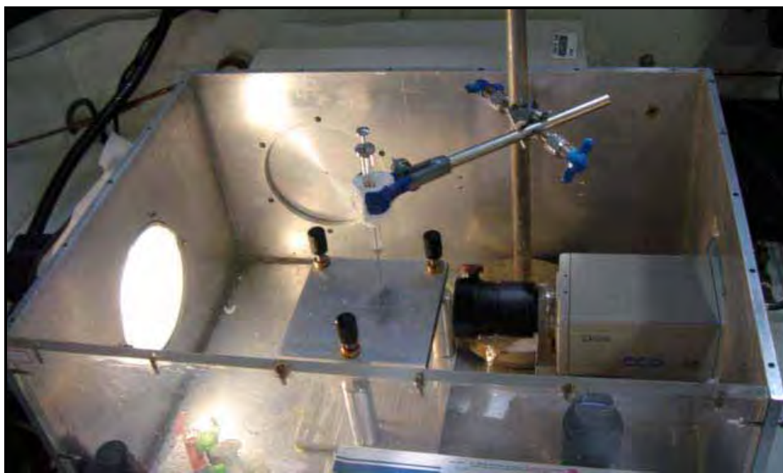
Figura 3. Sistema utilizado para avaliação do ângulo de contato de soluções contendo adjuvantes.
