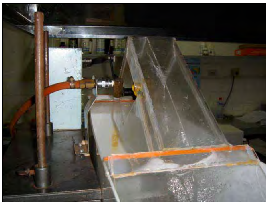
Figura 2. Sistema responsável pela movimentação da ponta de pulverização transversalmente ao feixe de luz.
