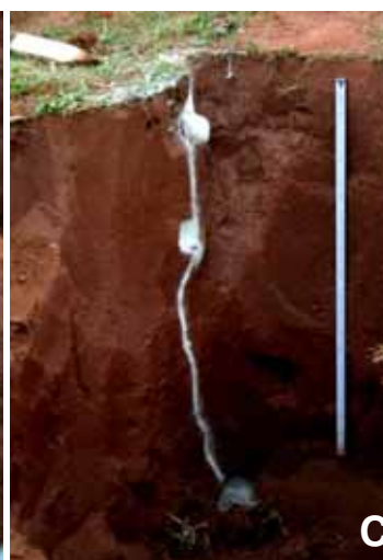
Figura 6. A) Vista geral do ninho 3 moldado com cimento; B) vista geral do subninho 1; C) vista geral do subninho 2 e D) vista geral do subninho 3.
