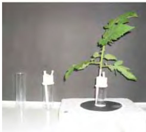
Figura 2 Folha de tomateiro contendo três folíolos inserida no interior de canudo plástico e acondicionada em recipiente de vidro (9 x 2,5 cm) vedado com membrana de látex.
