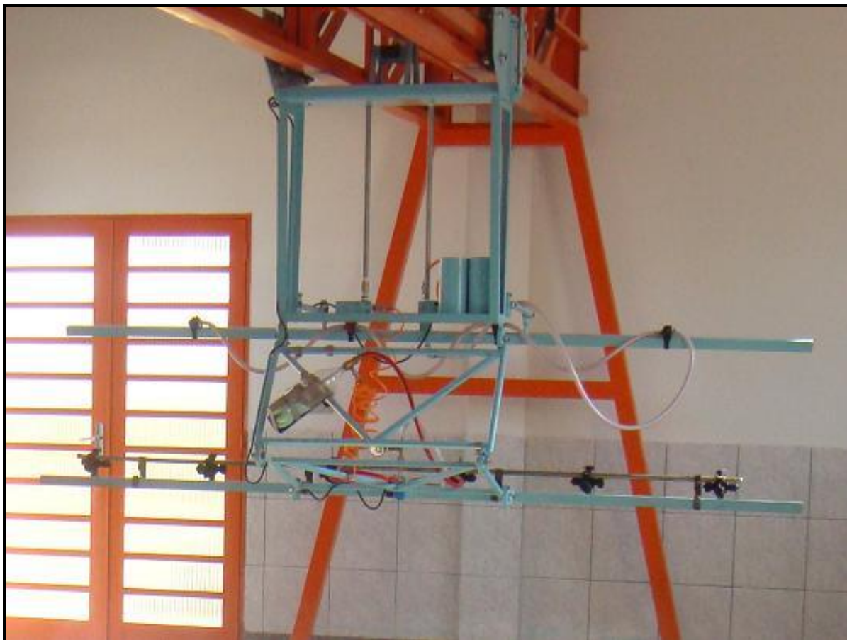
Figura 1. Sistema de pulverização com controle de velocidade e pressão de trabalho do Laboratório de Tecnologia de Aplicação de Defensivos da FCA/ UNESP – Campus de Botucatu/SP.
