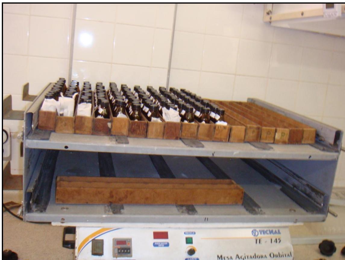
Figura 4. Mesa agitadora orbital TE-145, para agitação das amostras para análise da substância marcadora.
