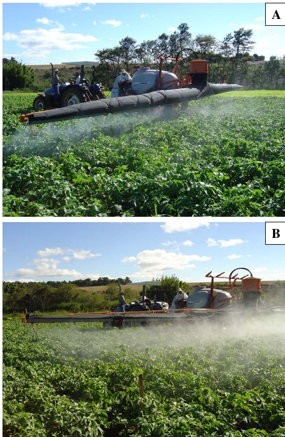
Figura 2. Pulverização com (A) e sem assistência de ar (B), junto à barra combinado ao ângulo de 30° a favor do deslocamento, na cultura da batata.
