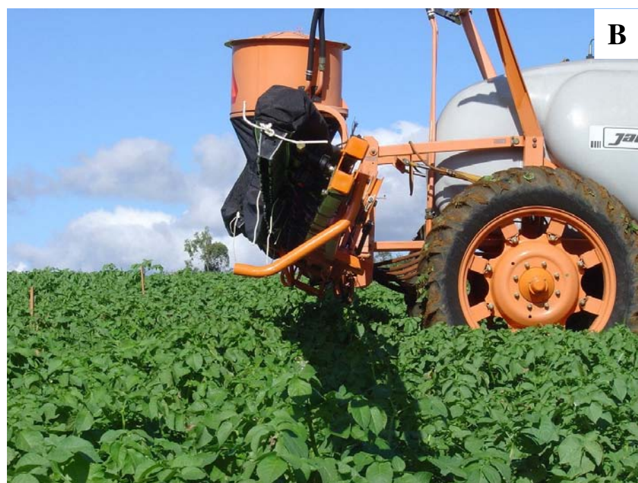
Figura 1. Angulação da barra de pulverização a favor do deslocamento do conjunto trator-pulverizador ( +30^\circ - A) e contra o deslocamento ( -30^\circ - B).
