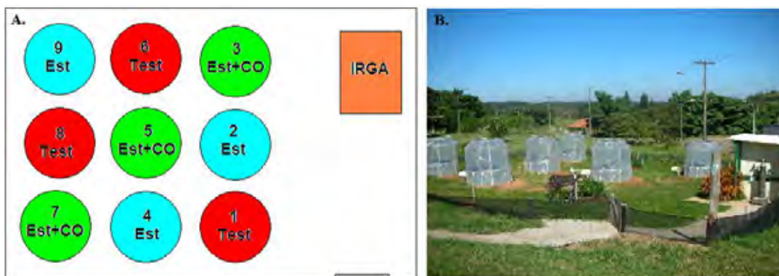
Figura 1A. Esquema da área experimental do ensaio com estufas de topo aberto sem (Est) ou com injeção de \text{CO}_2 (Est + \text{CO}_2 ) e sem estufa (Test); B. Foto da área experimental. IRGA = Infrared gas analyzer.
