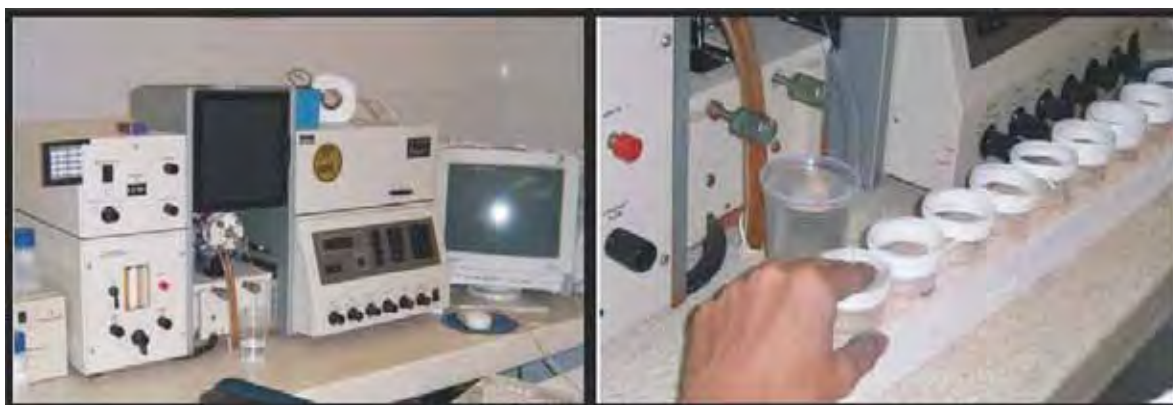
Figura 2. Espectrofotômetro de absorção atômica utilizado para a quantificação do íon cobre ( \text{Cu}^{+2} ), nas análises de deposição da pulverização e resíduo sobre frutos de laranja 'Valência': detalhe das leituras a direita.
