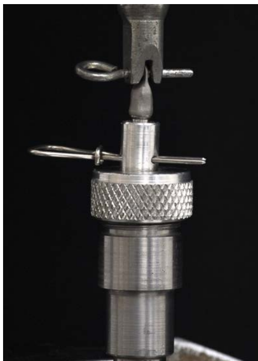
Figura 9 - Corpo-de-prova posicionado para a realização do ensaio de tração.
