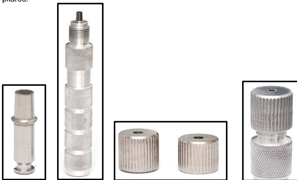
Figura 1 - Dispositivos metálicos utilizados para a padronização da secção dos pilares.
