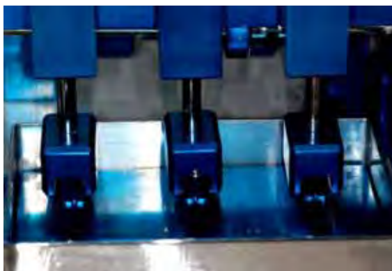
FIGURA 6– COMPARTIMENTO PARA POSICIONAMENTO DOS CORPOS-DE-PROVA E DAS SOLUÇÕES DE ESCOVAÇÃO.
