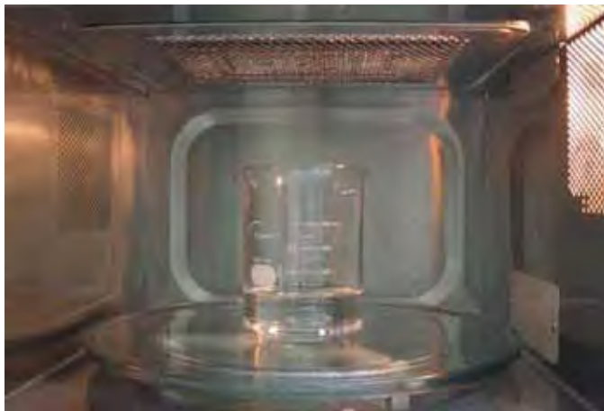
FIGURA 6 - Esterilização dos corpos-de-prova em micro-ondas.
