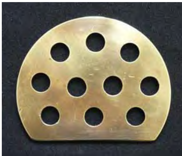
FIGURA 1 - Matriz metálica utilizada para confecção dos corpos-de-prova em resina acrílica.
