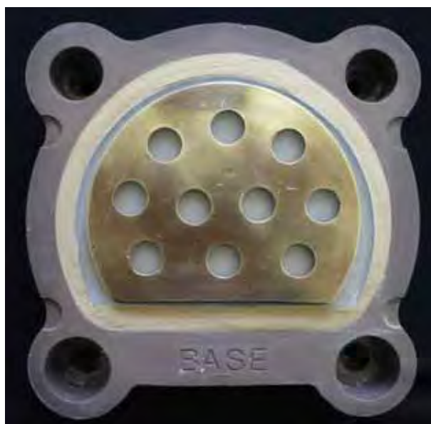
FIGURA 2 - Parte inferior da mufla preenchida com gesso sobre o qual está posicionada a placa de vidro.
