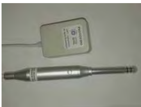
FIGURA 3 - Peça de mão . Aparelho de luz LED construído para iluminação das línguas dos animais.
