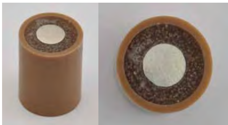
FIGURA 3 - Discos de Ti cp incluídos em tubo de PVC.
