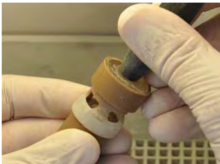
FIGURA 4 - Dispositivo para padronização do jateamento.
