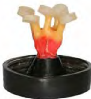
FIGURA 2 - Padrões de resina acrílica fixados na base de PVC.
