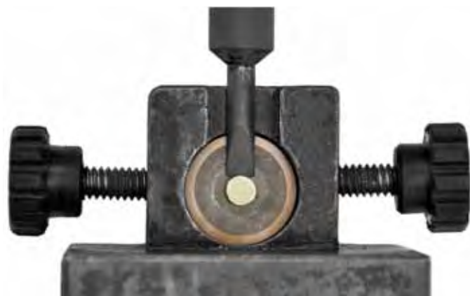
FIGURA 6 - Ensaio de cisalhamento da união.
