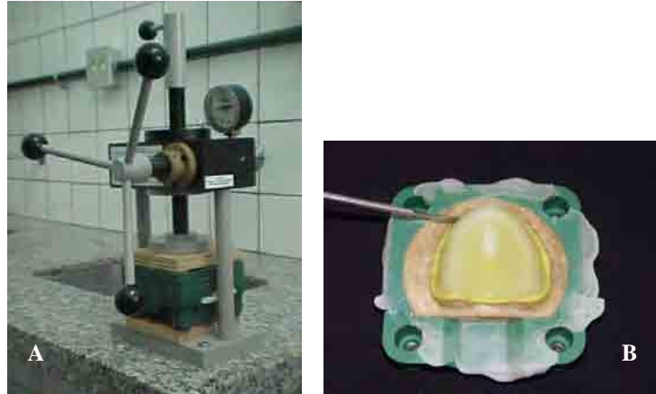
FIGURA 6: A- Prensagem de prova; B- Recorte dos excessos com buril de Le Cron.
