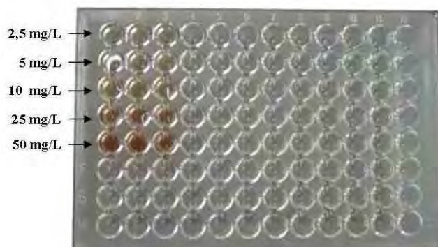
FIGURA 6 – Placa de orifícios com 15 amostras de suspensão celular associadas ao Photogem ® em cinco diferentes concentrações.
