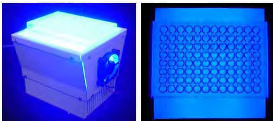
FIGURA 7 – Placa de orifícios posicionada sobre a superfície de iluminação da Bio Table acionada.
