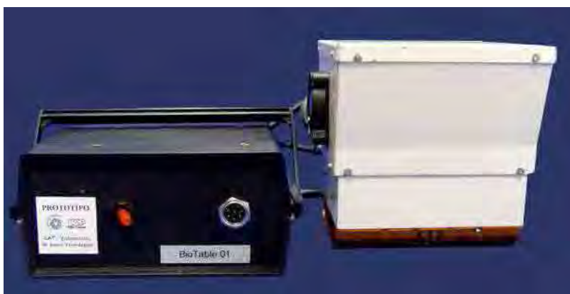
FIGURA 4 – Bio Table - Aparelho constituído de LEDs utilizado para iluminação das amostras.
