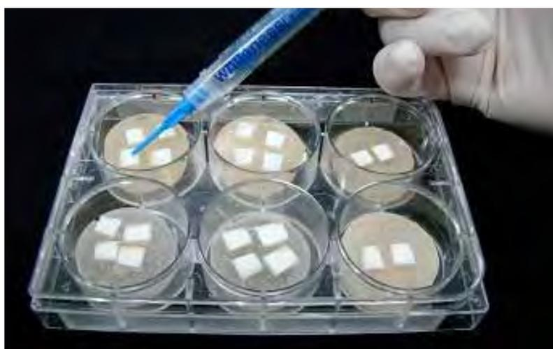
**FIGURA 9** - Blocos de esmalte incluídos em resina acrílica e posicionados na placa de 6 compartimentos para realização do procedimento clareador.
