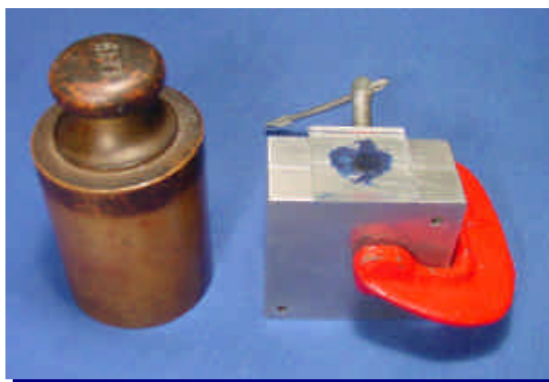
FIGURA 3 – Matriz posicionada verticalmente com cavidade preenchida com cera
