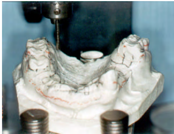
FIGURA 4 – Fixação do pino ao mandril do delineador de bancada.
