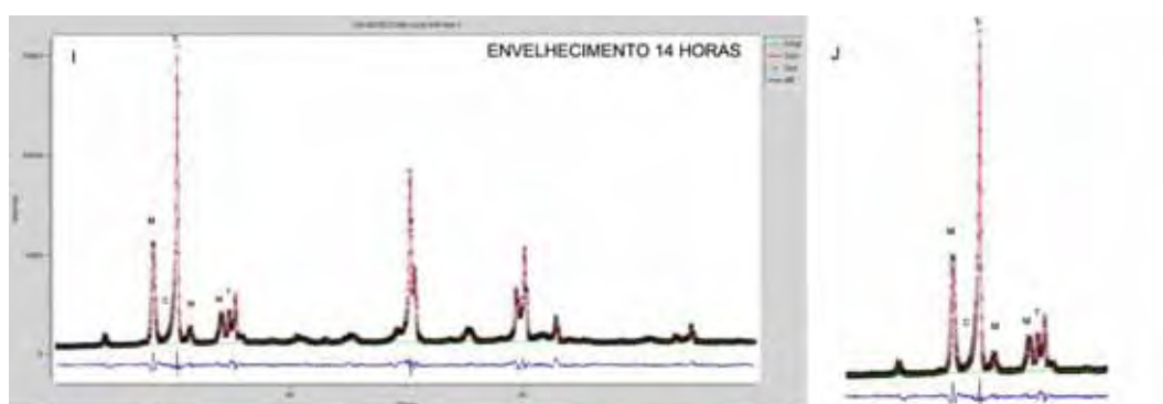
Figura 66 Gráficos obtidos através da técnica de Refinamento por Rietveld após envelhecimento em reator hidrotérmico pressurizado: I e J) 14 horas.
