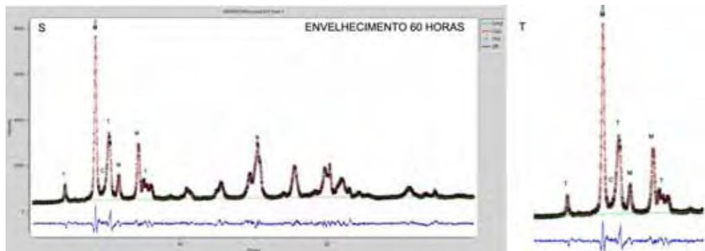
Figura 71- Gráficos obtidos através da técnica de Refinamento por Rietveld após envelhecimento em reator hidrotérmico pressurizado: S e T) 60 horas.
