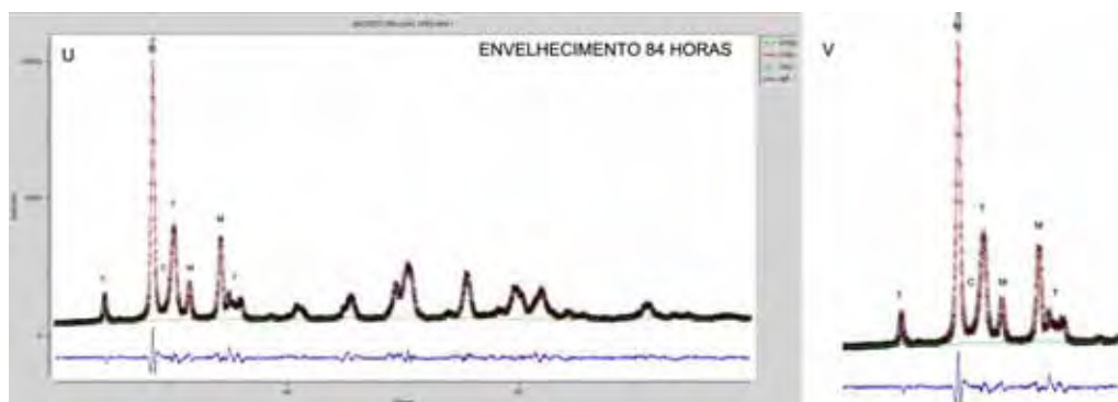
Figura 72- Gráficos obtidos através da técnica de Refinamento por Rietveld após envelhecimento em reator hidrotérmico pressurizado: U e V) 84 horas.
