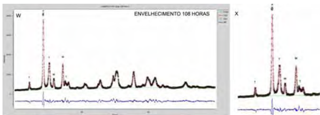
Figura 73- Gráficos obtidos através da técnica de Refinamento por Rietveld após envelhecimento em reator hidrotérmico pressurizado: W e X) 108 horas.
