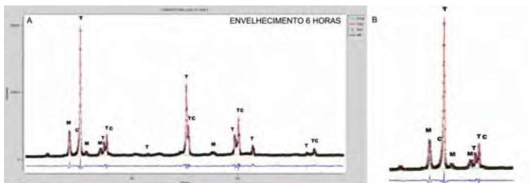
Figura 62- Gráficos obtidos através da técnica de Refinamento por Rietveld após envelhecimento em reator hidrotérmico pressurizado: A e B) 6 horas.
