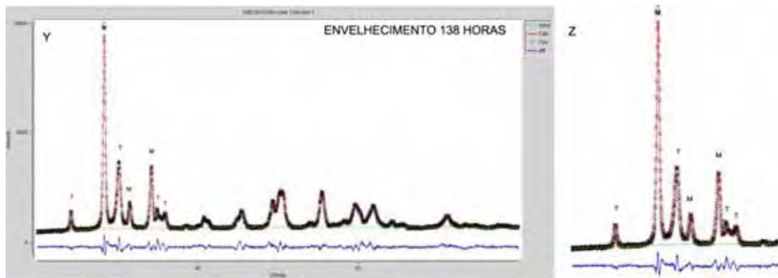
Figura 74- Gráficos obtidos através da técnica de Refinamento por Rietveld após envelhecimento em reator hidrotérmico pressurizado: Y e Z) 138 horas.
