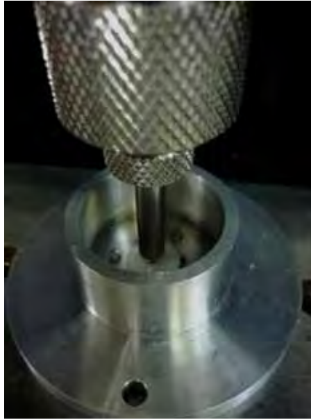
Figura 11- fotografia do momento do ensaio de flexão biaxial.
