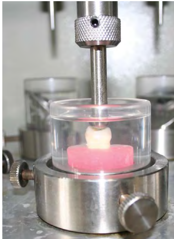
Figura 8 - Simulador de Fadiga Mecânica ER-11000 Plus- ERIOS®: base metálica com um ângulo de 90° e haste superior (8 mm de diâmetro).
