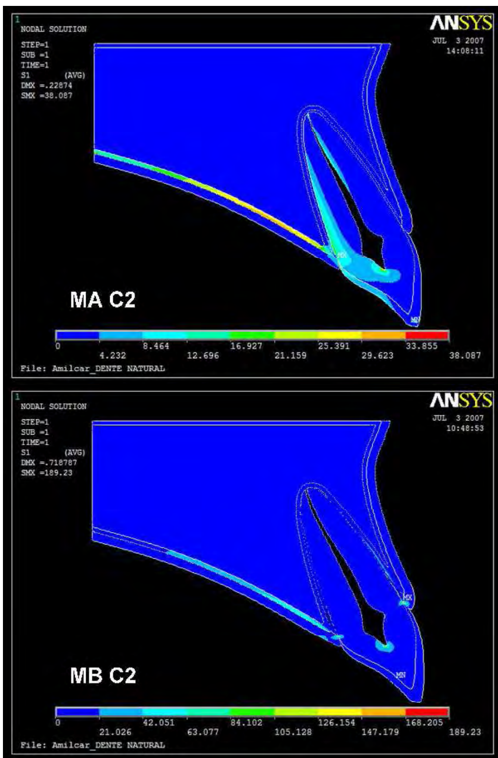
Figura 18 – Mapas gerais para a concentração máxima principal em tensão ( \sigma_{max,t} ) nos modelos MA e MB sob a condição de carregamento C2.
