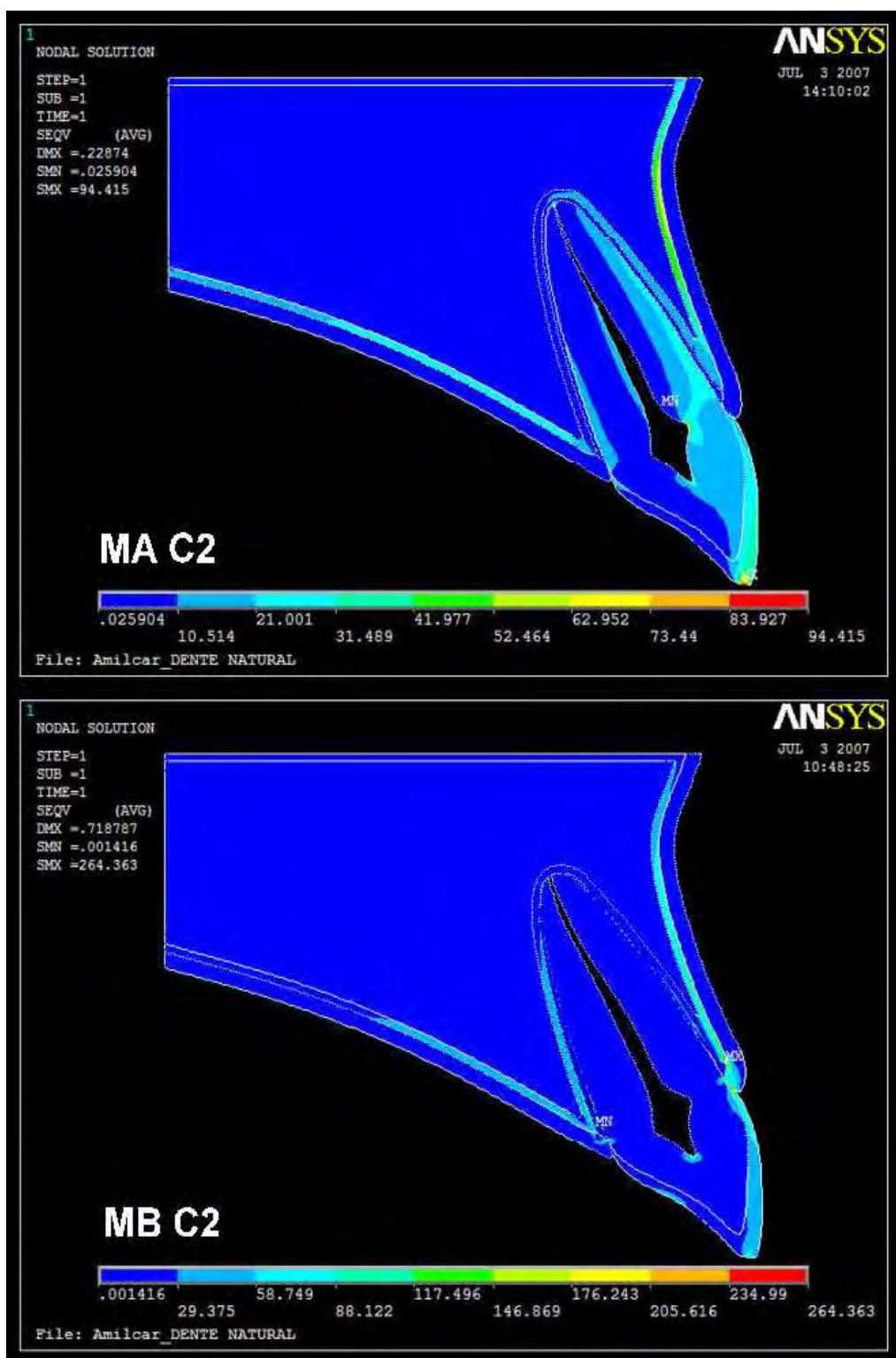
Figura 15 – Mapas gerais para o critério das tensões equivalentes de von Mises ( \sigma_{VM} ) nos modelos MA e MB sob a condição de carregamento C2.
