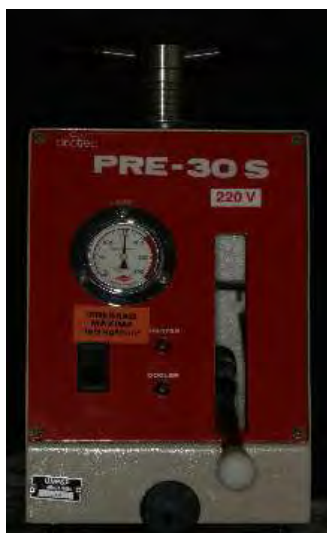
Figuras 4 e 5 – O conjunto “implante - pilar zircônia – coroa total” foi incluído em resina acrílica em embutidora metalográfica (Arotec PRE 30S, Arotec S.A. Ind. e Com., Cotia, SP, Brasil) por 20 minutos sob calor e pressão constante de 150Kgf/cm 3 .
