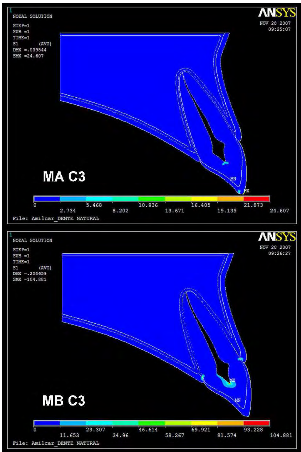
Figura 19 – Mapas gerais para a concentração máxima principal em tensão ( \sigma_{max,t} ) nos modelos MA e MB sob a condição de carregamento C3.
