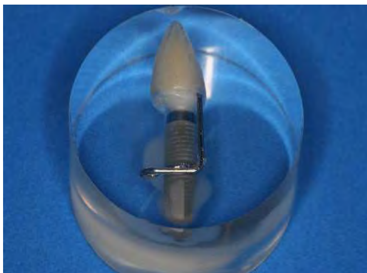
Figuras 4 e 5 – O conjunto “implante - pilar zircônia – coroa total” foi incluído em resina acrílica em embutidora metalográfica (Arotec PRE 30S, Arotec S.A. Ind. e Com., Cotia, SP, Brasil) por 20 minutos sob calor e pressão constante de 150Kgf/cm 3 .
