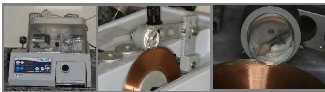
Figura 6 – O conjunto incluído foi seccionado ao meio através de uma recortadora (Isomet - Buehler, Lake Bluff, IL, USA).
