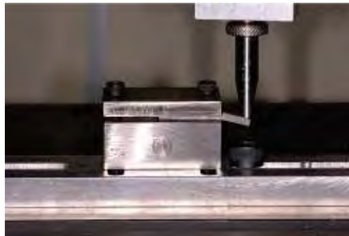
Figura 5 - Barra deformada pela ação da célula de carga da máquina de ensaio mecânico Universal.
