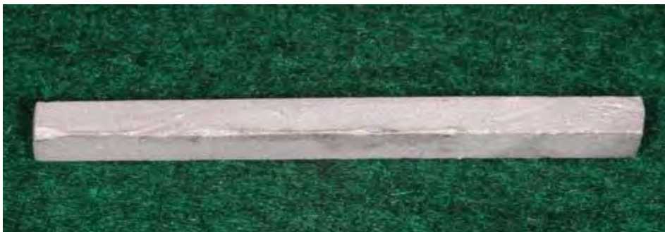
Figura 4 - Barra quadrada concluída para ser submetida à carga de compressão.
