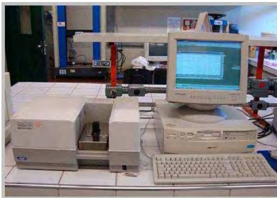
Figura 3. Espectrofotômetro UV-Vis Shimadzu Multspec 1501 utilizado durante a síntese para acompanhar a formação das nanopartículas de prata.
