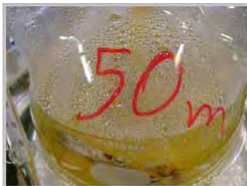
Figura 2. Solução coloidal de nanopartículas de prata com tonalidade amarelo âmbar, que é um dos indicativos da formação destas nanopartículas.
