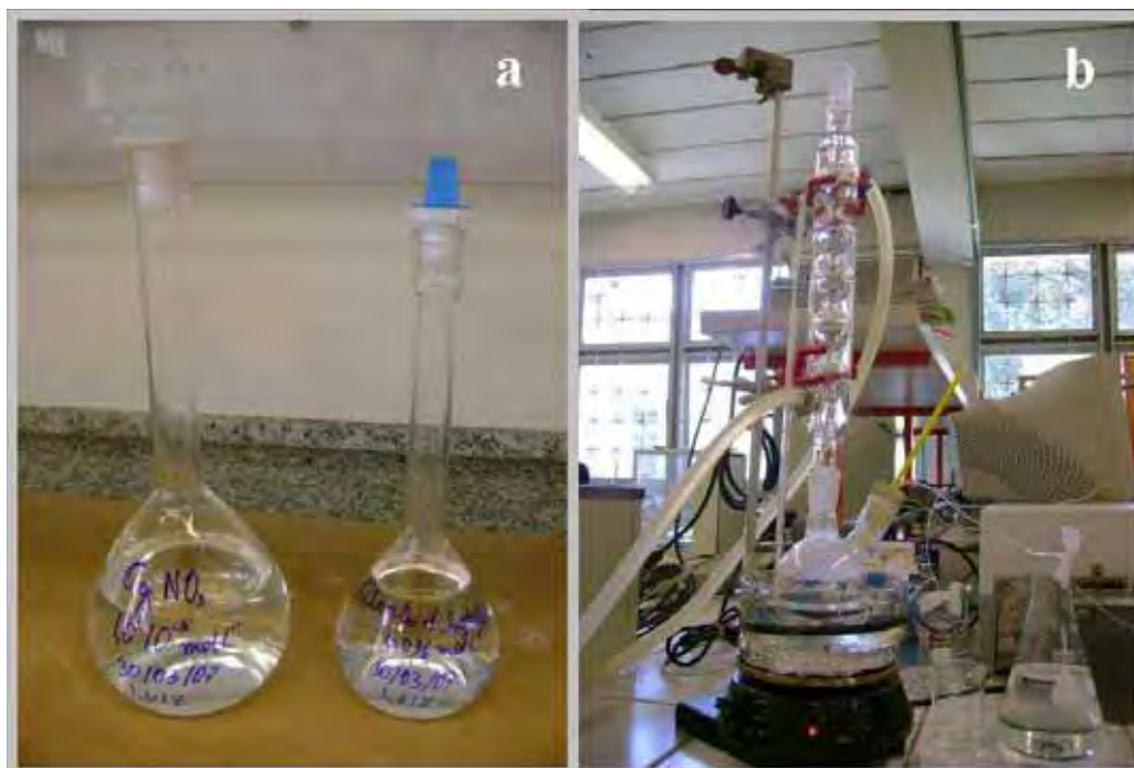
Figura 1. a) Soluções de nitrato de prata e citrato de sódio utilizadas na síntese das nanopartículas de prata; b) balão de fundo redondo conectado a um condensador e ao espectrofotômetro de UV/Vis, contendo no seu interior as soluções que foram mantidas sob agitação magnética e aquecimento a 97°C por cerca de 10 minutos.
