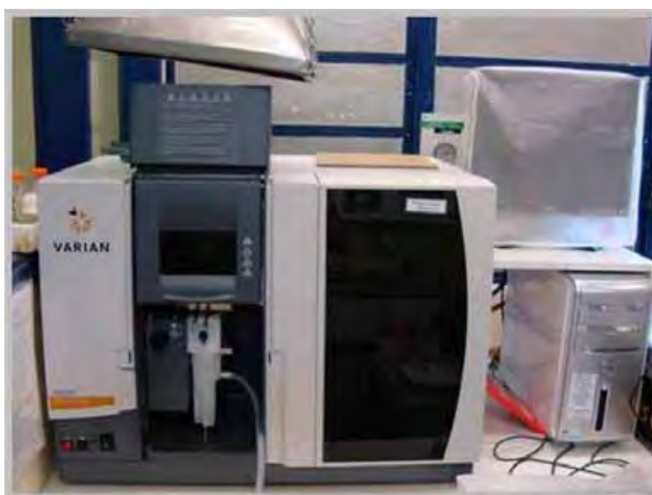
Figura 14. Espectrofotômetro de absorção atômica Varian AA240FS utilizado para avaliar a presença de prata nas amostras.
