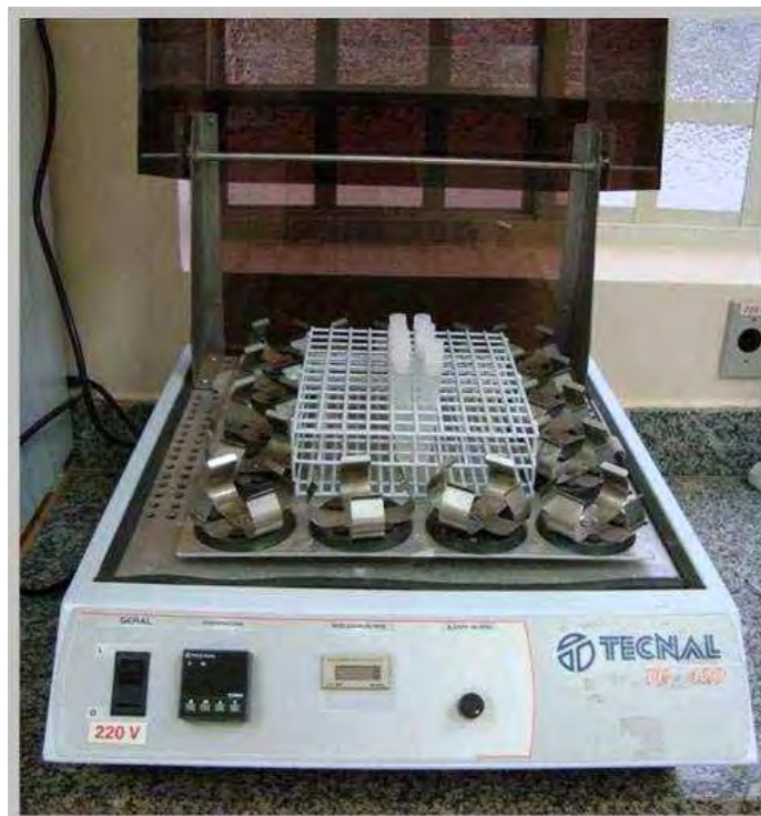
Figura 13. Agitador orbital Tecnal TE 420. Suporte metálico para contenção dos tubos de polipropileno encaixado sobre a plataforma agitadora.
