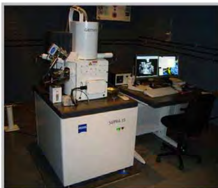
Figura 17. Microscópio eletrônico FEG-VP Zeiss Supra 35 utilizado na obtenção das micrografias para análise morfológica dos espécimes.
