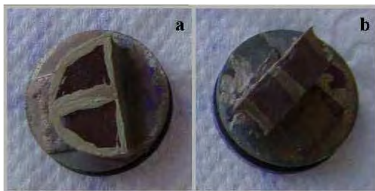
Figura 16. Preparação dos espécimes para análise por meio de MEV. Deposição de ouro sobre as superfícies dos espécimes: a) superfície externa e b) superfície interna do espécime após fratura criogênica.
