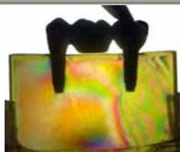
Fig. 27 - Aplicação de carga oblíqua no molar - HI - Prótese Parafusada.
