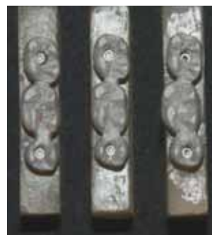
Fig. 8- Coroas metálicas múltiplas nos modelos fotoelásticos.
