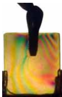
Fig. 14- Modelo unitário –HI- parafusada - carga oblíqua.
