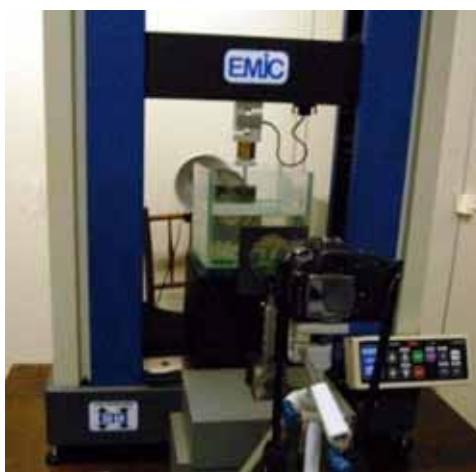
Fig. 23: Máquina de Ensaio Universal (EMIC – DL 3000), acoplado o polariscópio circular.
