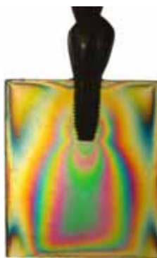
Fig. 11- Modelo de prótese unitária -HI- parafusada -carga axial.
