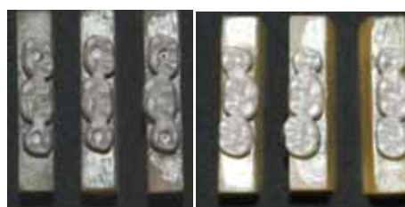
Fig. 5-Coroas cimentadas e parafusadas adaptadas aos modelos fotoelásticos.
