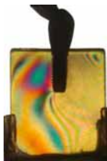
Fig. 13- Modelo unitário –HE- parafusada - carga oblíqua.
