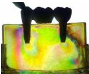
Fig. 16 – Aplicação de carga oblíqua no pré-molar -HI- Prótese Parafusada.
