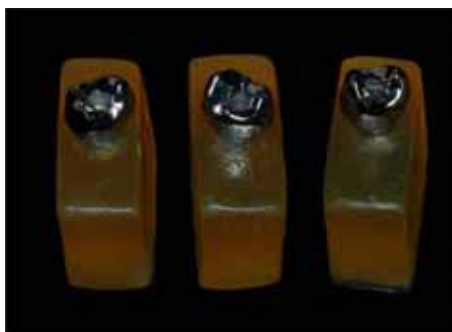
Fig. 7- Coroas metálicas unitárias parafusadas nos modelos fotoelásticos.
