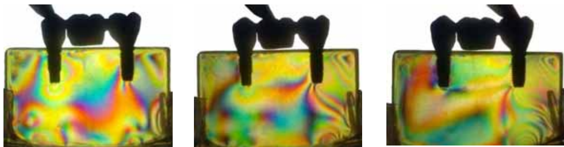
Fig. 19 – Aplicação de carga oblíqua no pré- molar -HE- Prótese Parafusada.
