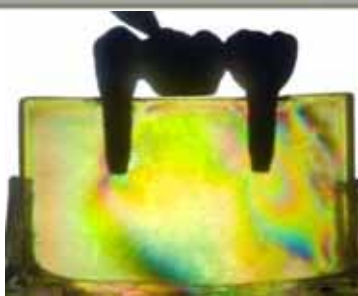
Fig. 26 - Aplicação de carga oblíqua no pântico - HI - Prótese Parafusada.
