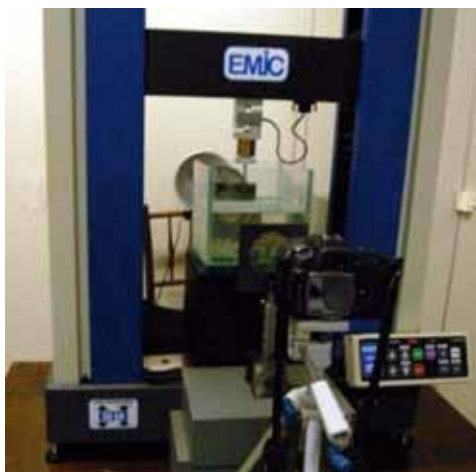
Fig. 6: Máquina de Ensaio Universal (EMIC – DL 3000), acoplado o polariscópio circular.
