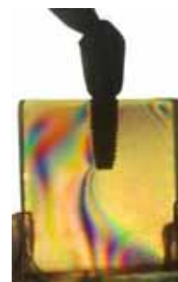
Fig. 15- Modelo unitário –CM- parafusada - carga oblíqua.
