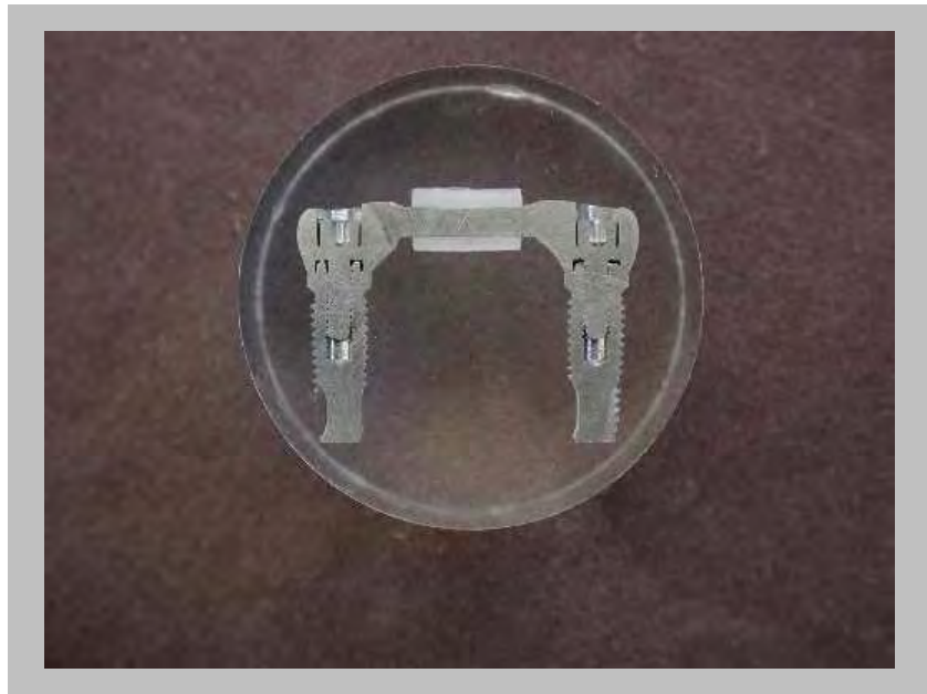
Figura 5. Conjunto barra-clipe após secção em recordadeira, possibilitando visualização dos passos de rosca, da superfície interna e da adaptação entre os componentes e os implantes.
