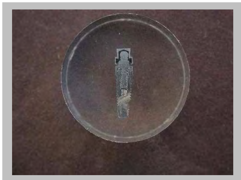
Figura 6. Conjunto esférico após secção em recordadeira, possibilitando visualização dos passos de rosca, da superfície interna e da adaptação entre os componentes e o implante.
